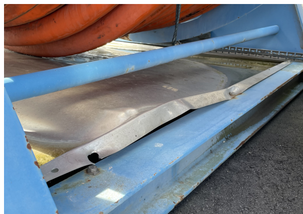
Figur 6.4: Dryppskål under trommel er skadet.
