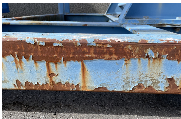
Figur 6.1: Overflaterust på reelens ramme.
