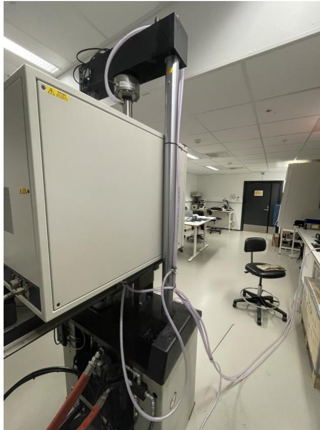
Bilde 3: Vannrør brukt for nedkjøling av maskinen.
