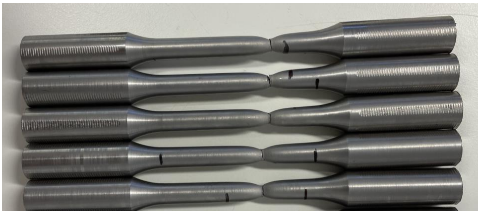
Bilde 6: Prøvestavene etter brudd (22 °C).
