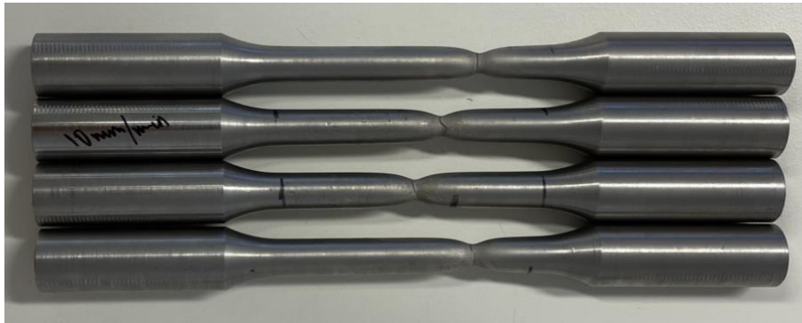
Bilde 8: Prøvestavene etter brudd (-46 °C).
