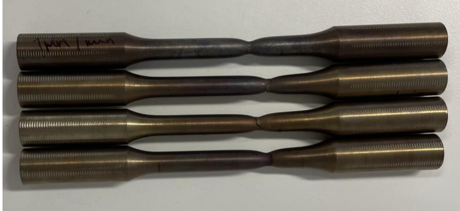
Bilde 7: Prøvestavene etter brudd (300 °C).
