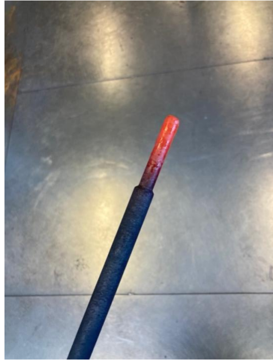
Figur 20: Punteljernet er rødglødende.
