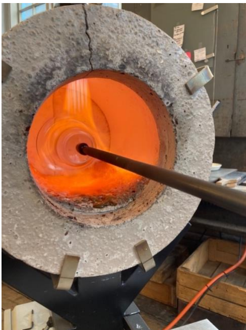
Figur 38: Stor åpning i innvarmingsovnen til vid skål.
