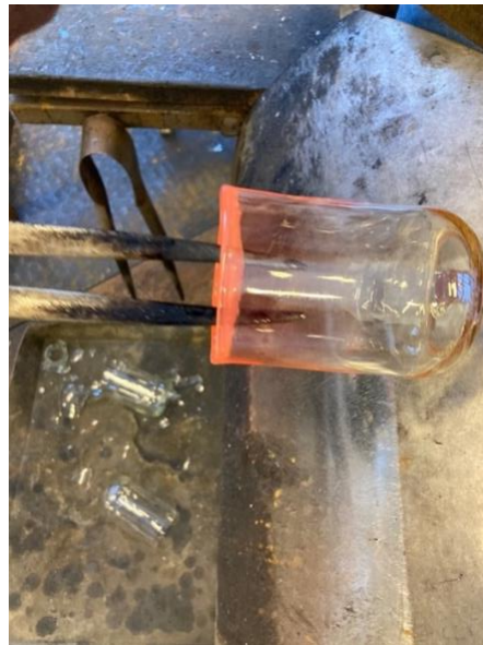
Figur 34: Pulveret har smeltet etter innvarming.
