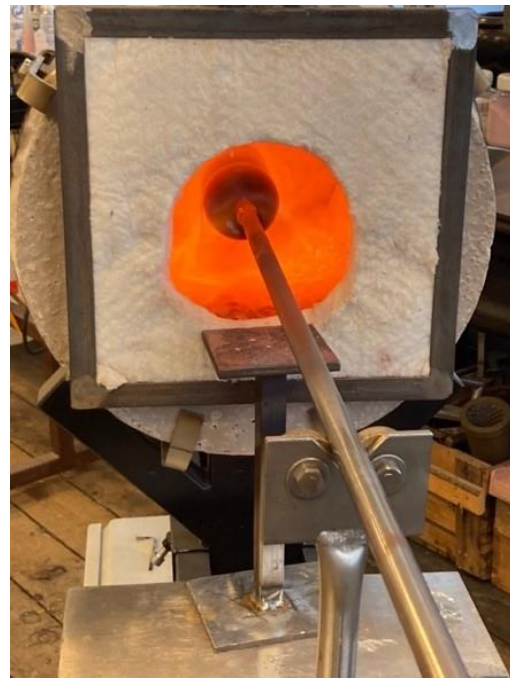
Figur 23: Puntelen som festes i midten av flaskebunnen. Figur 24: Flasken varmes i innvarmingsovnen.
