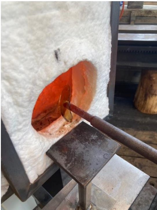
Figur 21: Glass-skåret festes til punteljernet.
