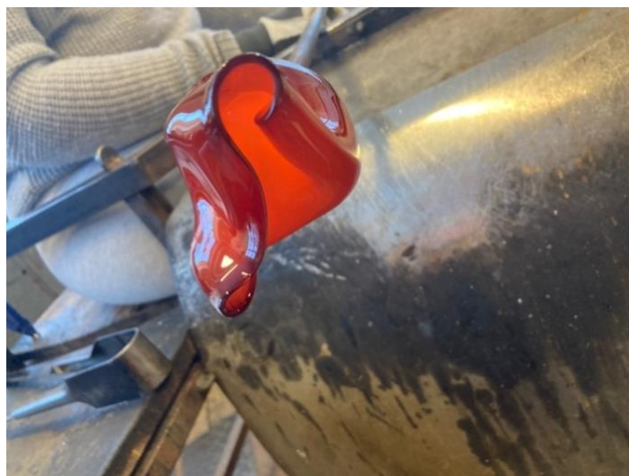
Figur 32: En av elevene har varmet for hardt slik at glasset kollapser.
