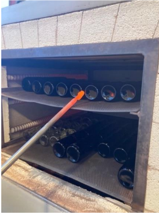
Figur 23: Puntelen som festes i midten av flaskebunnen. Figur 24: Flasken varmes i innvarmingsovnen.
