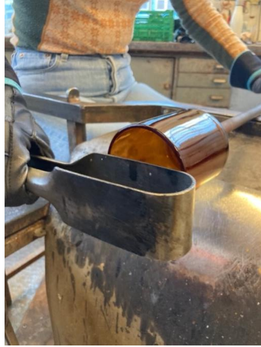
Figur 31: Eleven bruker buen for å rette kanten.
