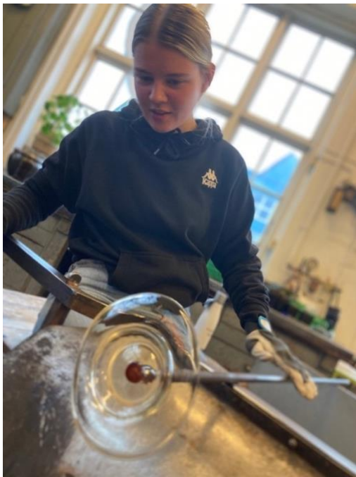
Figur 40: Sentrifugalkraften åpner flasken til å bli et fat. opp kanten.
