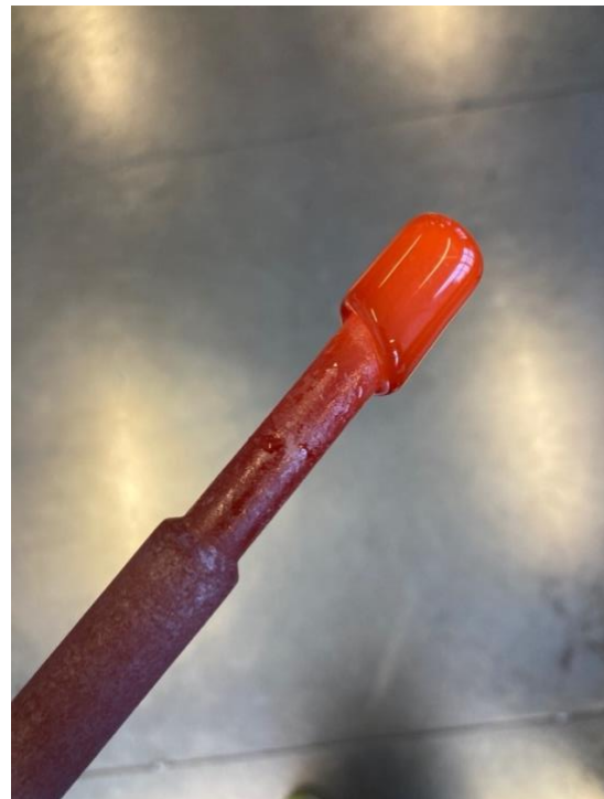
Figur 22: Glass-skåret er smeltet ned og formet rundt jernet.
