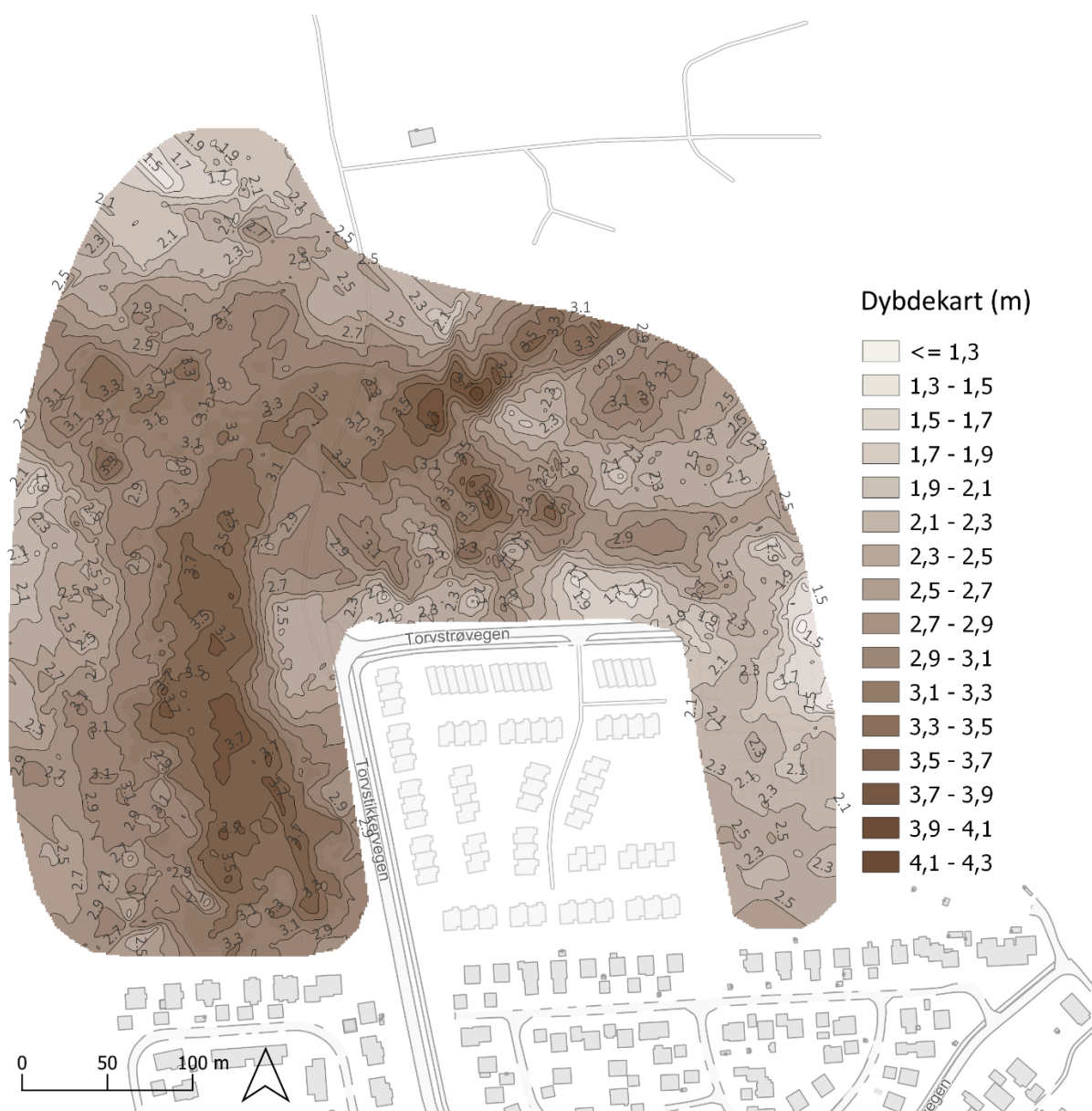
Figur 11. Dybdekart for studieområdet med dybder estimert ut fra georadarmålinger. Fargespekteret visualiserer dybden.
