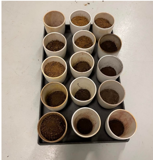
Figur 9. Torvprøver i digeler. Prøvene er siktet ned til finjord med kornstørrelse mindre enn 2 mm.
