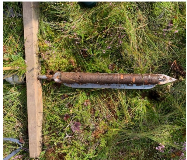
Figur 8. Russerbor med torvprøve. Vi tok ut prøver på 10 cm.
