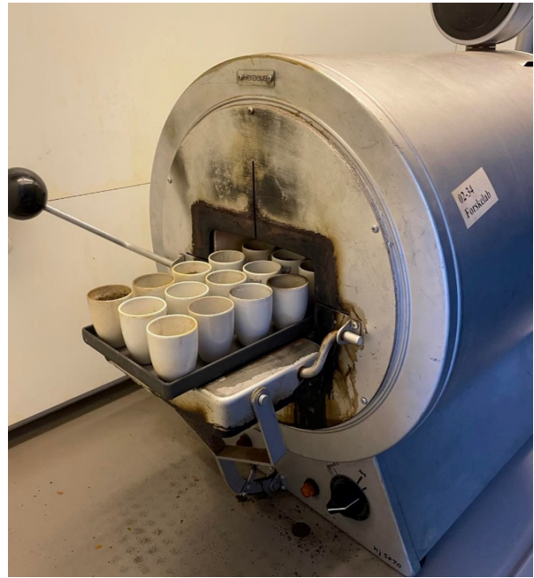
Figur 10. Torvprøver på vei inn i glødeovn som holder 550°C.
