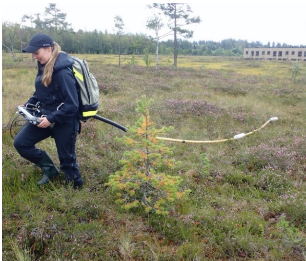
Figur 7. Dybderegistreringer med Georadar. Georadarverktøyet festes på en person som går i gangfart.
