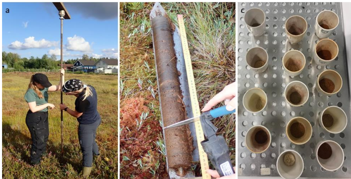
Figur 8. Høyden leses av på russerboret under feltarbeidet i planområdet (a). En 10 cm lang torvprøve ble skjært ut fra russerboret, og dybden til prøven ble leset av på målestokken (b). Et utvalg av torvprøvene etter gløding i ovn. I bunnen av diglene lå det restmaterialer (c).
