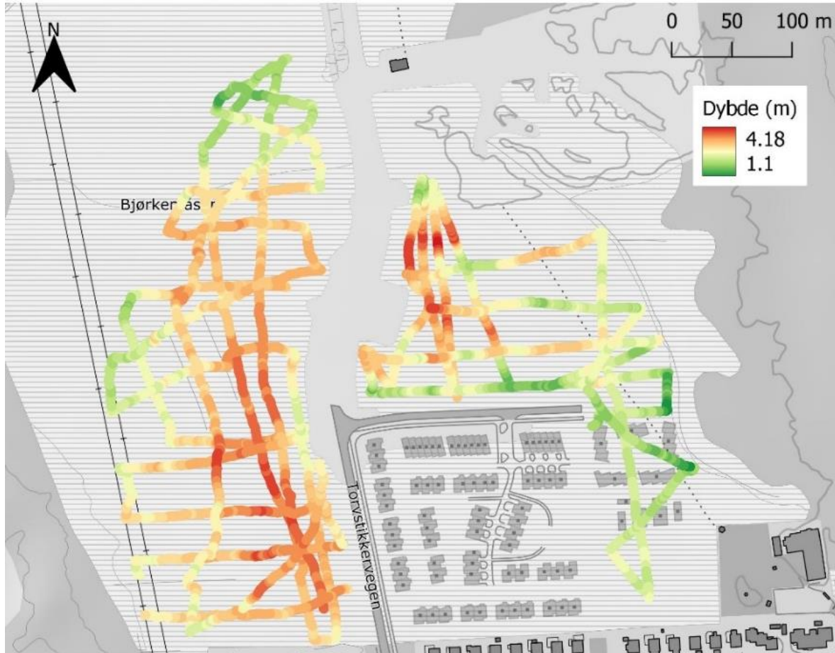
Figur 1. Tolkede profiler ble eksportert til Qgis, der fargerike linjer viser dybden. Rød er dypest og grønn er grunnest.
