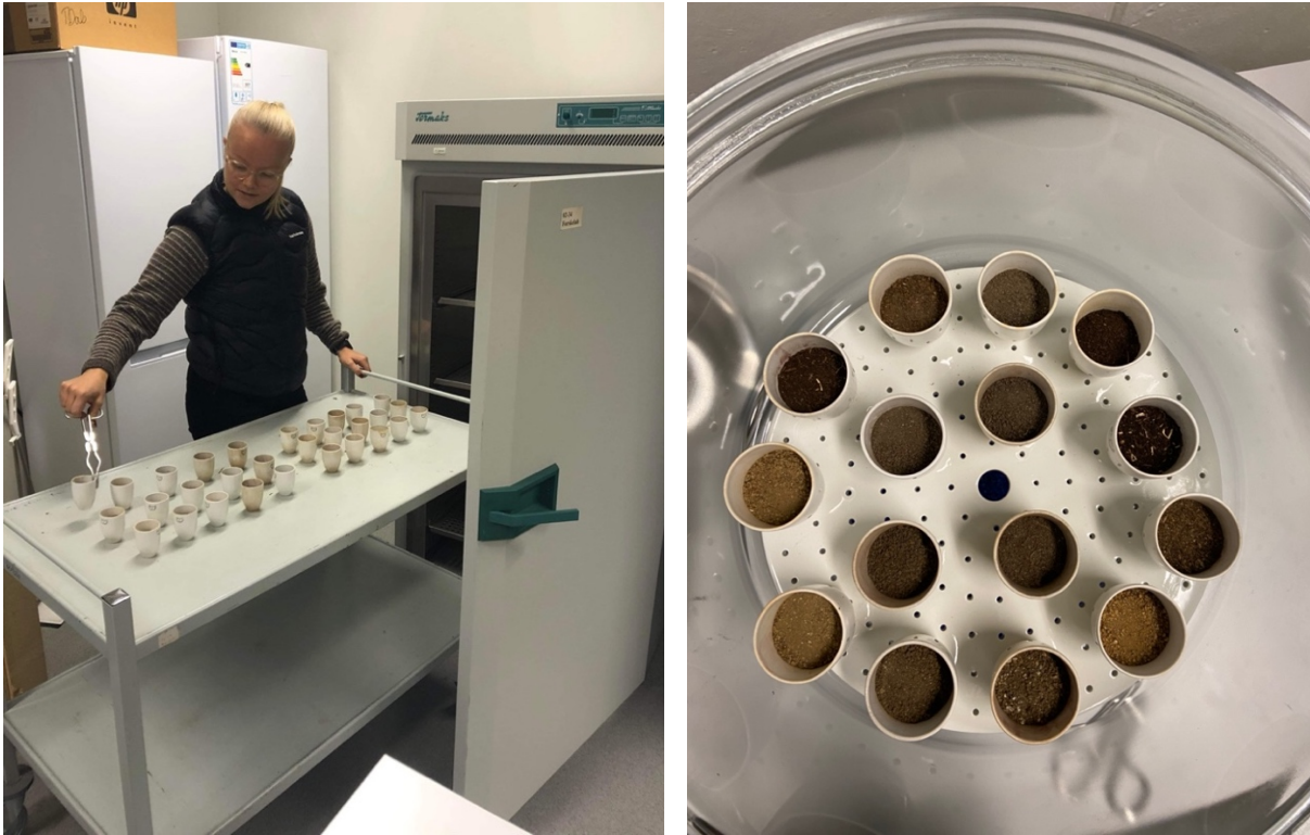
Figur 7: Jordprøver tas ut av tørkeskap (t.v.) og settes i eksikkator (t.h.)
