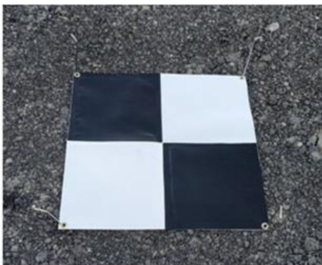
Figur 63: Eksempel på hvordan PVC-presenningene kan oppføre seg på hardt underlag (bilde til venstre) og mjukt underlag (bilde til høyre). Gjerdrum 5. april 2022.
