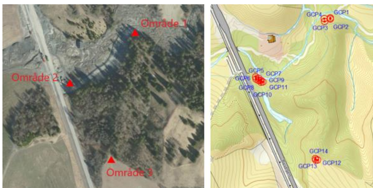
Figur 29: Figuren til venstre viser de tre hovedområdene hvor vi plasserte ut GCP-ene (Gemini Terreng). Figuren til høyre viser nøyaktig plassering (Gemini Oppmåling).
