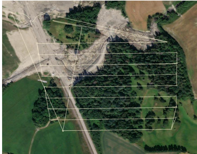
Figur 14: Utklipp av flyrute for DJI Matrice 300, fra datafangst av HVL2 i Gjerdrum april 2022. ArcGIS Pro.
