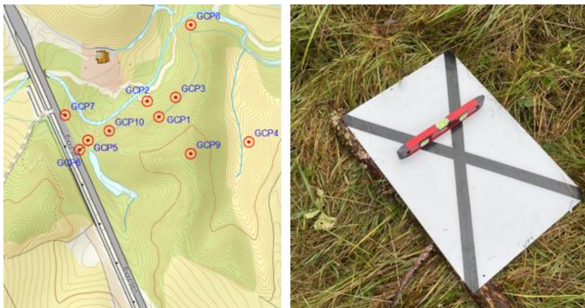
Figur 26: Utklippet til venstre illustrerer posisjonen til de utsette GCP-ene (Gemini Oppmåling). Figuren til høyre viser nærbilde av en av de 10 GCP-ene (Gjerdrum 6. oktober 2021).
