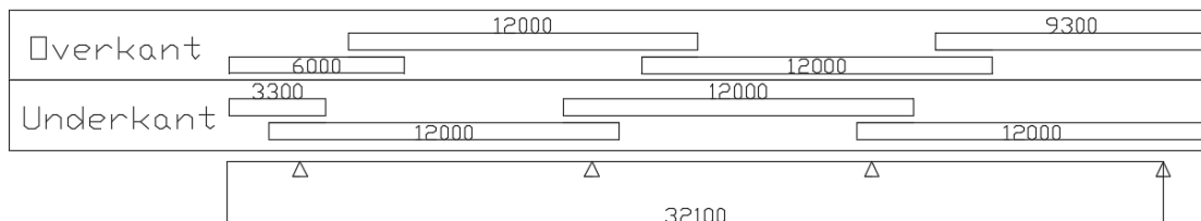
Figur 5.8: Skjøting av armering
