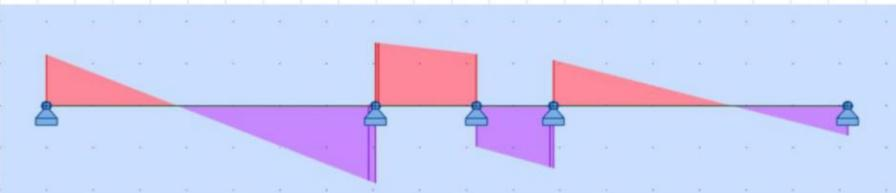
Over ser man et bilde av hvordan skjærdiagrammet for plate 209- 211 og drager er utformet.
