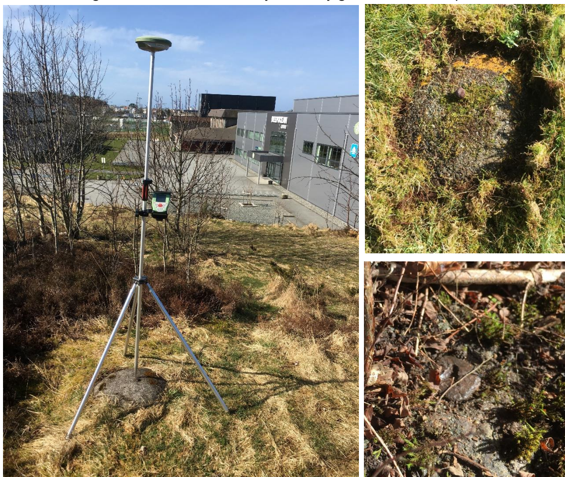
Figur 18 viser til venstre innmåling av Dahls triangelpunkt nr. 3, øverst til høyre et nærbilde av Dahls triangelpunkt III (Skiftun) og nederst til høyre et nærbilde av Dahls triangelpunkt nr. 2, hvor man ser at det er et kryss på bolten.
