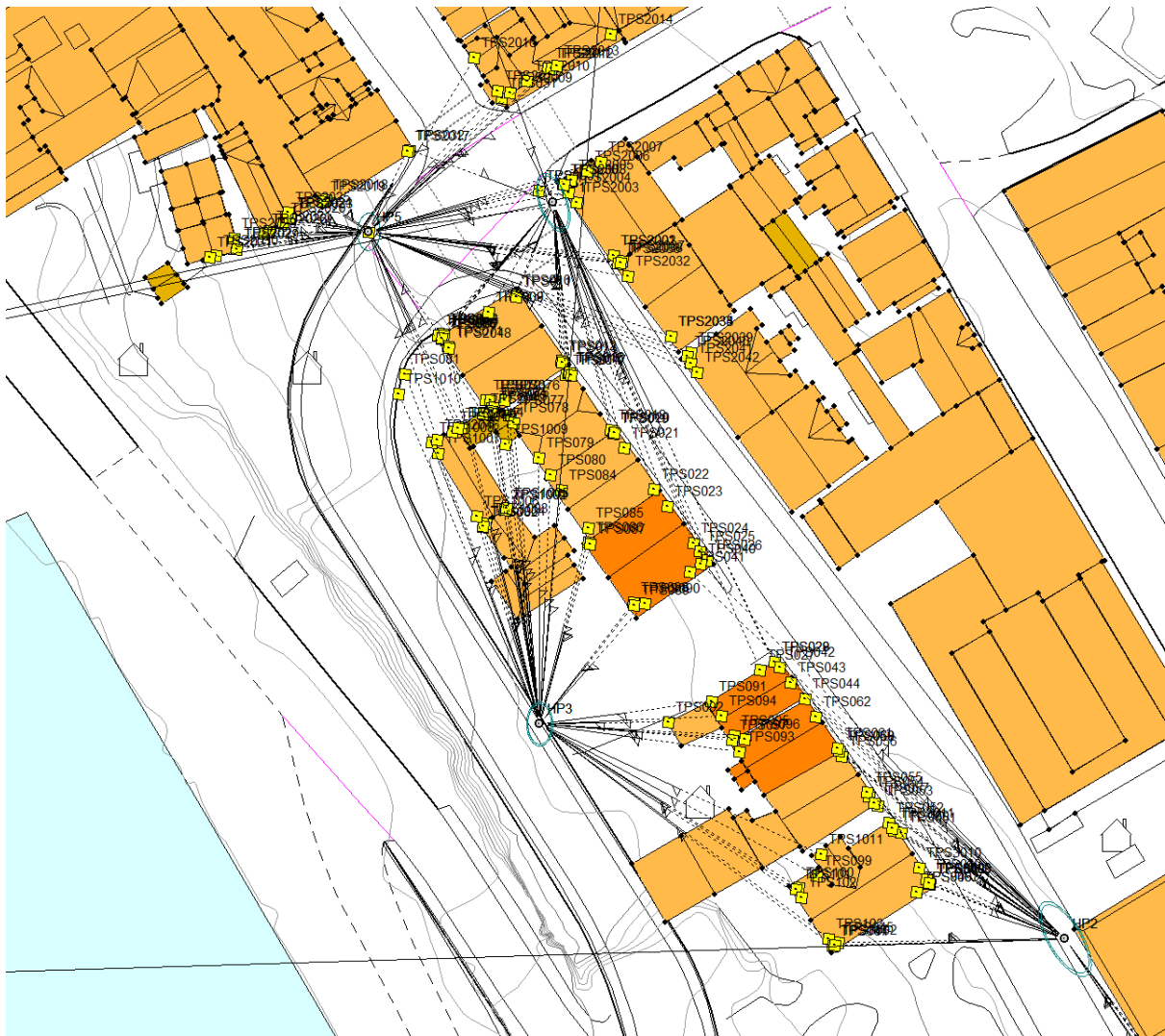
Figur 23 viser hvordan detaljmålingen ble gjennomført og hva som ble målt inn av detaljer. Oppstillingspunktene er vist med blå feilellipser rundt. Ikke alle kvartaler lar seg måle inn som dette (for det meste av kvartalet er revet).
