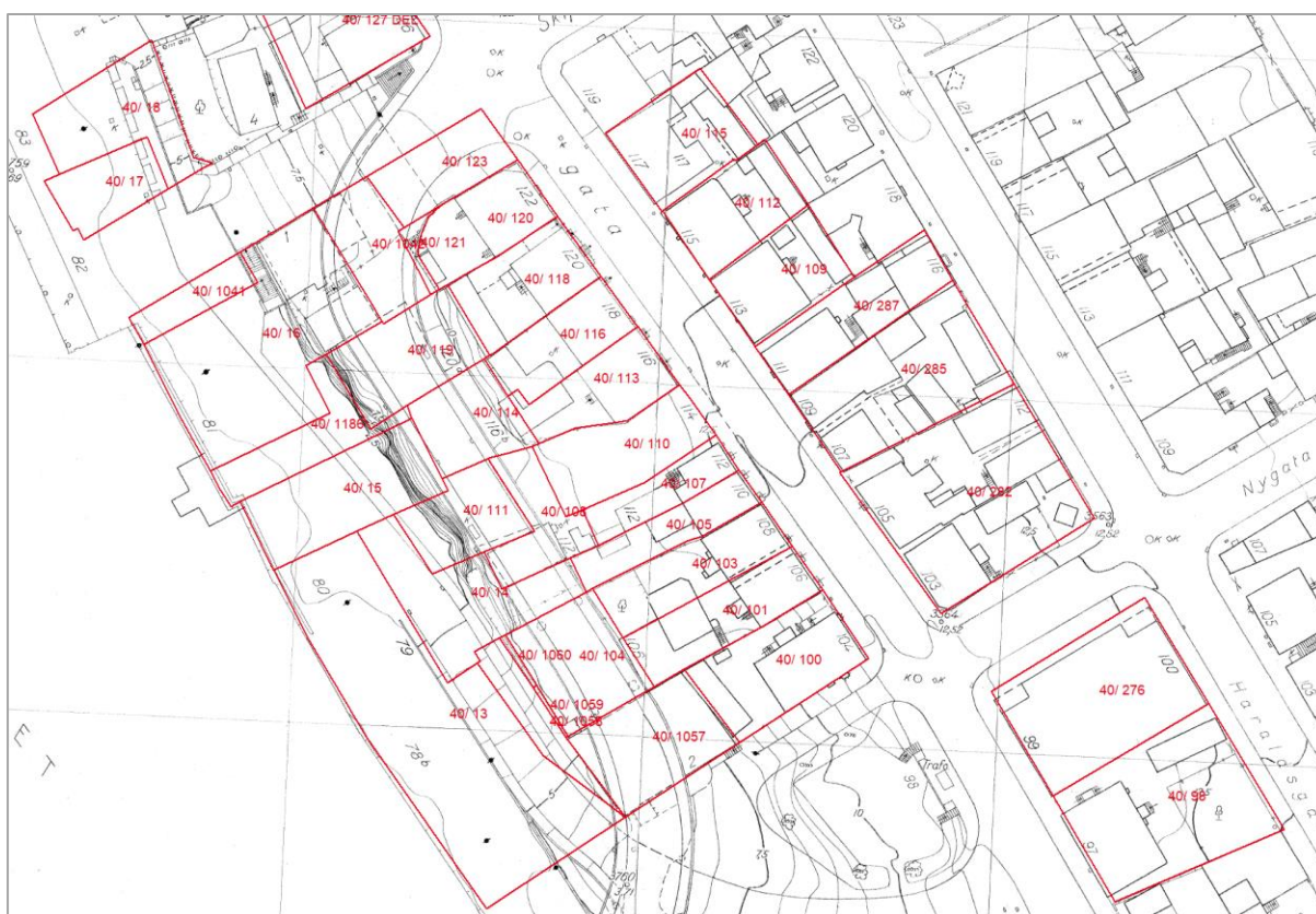
Figur 38 viser øverst resultatet av rekonstruksjonen i matrikelkartet og nederst resultatet av rekonstruksjonen med økonomisk kartverk fra 1958 som bakgrunn. Polygonpunktene markert i kartet er brukt som fikspunkter for georefereringen til de samme polygonpunkter i fastmerkebasen.
