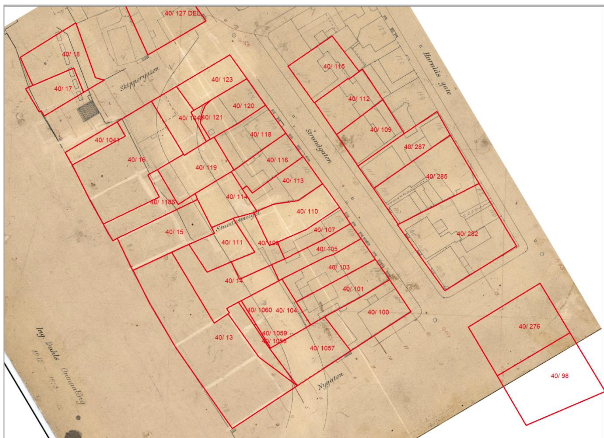
Figur 34 viser resultatet av rekonstruksjonen med kartblad 31 d i Dahls kartserie i 1:500 som bakgrunn. Polygonpunktene vist i kartbladet er fiksert til de transformerte polygonpunkter beskrevet tidligere.
