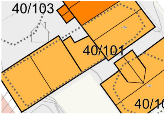
Figur 2 viser en «deformert» sirkeleieendom, hvor det er plassert et søknadspliktig tiltak etter plan- og bygningsloven på arealet uten at det er krevd oppmålingsforretning for å plassere tiltaket.
