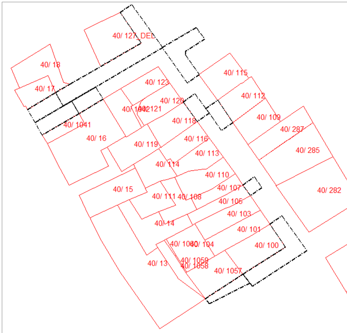
Figur 39 viser det rekonstruerte kvartal med gategrunnen registrert i målebrev på begge sider av gaten. Gategrunnen registrert i målebrevene er angitt med svart stiplet linje, og grensene innenfor de fra gammelt av regulerede gater med røde linjer. Som det ses er det kun ganske få av eiendommene, hvor gategrunnen faktisk følger med. Hvordan skal man fortolke målebrevene, og kan man egentlig stole på dem, når det gjelder gategrunnen?
