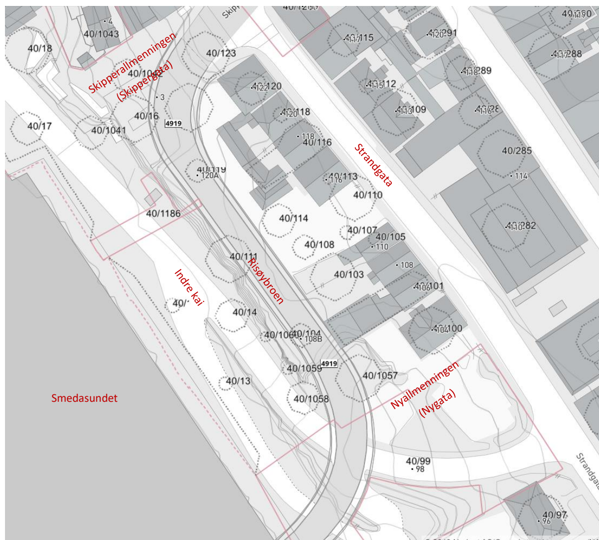
Figur 15 gjengir et utsnitt av matrikkelkartet med bakgrunnskart som viser kvartalet ved Risøybroen som ble valgt for rekonstruksjon av eiendomsgrenser på bakgrunn av målebrev og annen offentlig dokumentasjon. Utsnittet er påført gatenavn m. m. for å tydeliggjøre situasjonen. Kvartalet avgrenses i øst av Strandgata, i nord av Skipperallmenningen (og rampen til Risøybroen), i sør av Nyallmenningen som i dag brukes til parkering og atkomstvei til Indre kai og mot vest av Indre kai mot Smedasundet (sjøen). Kvartalet gjennomskjæres på langs av brolegemet til Risøybroen. Kilde: Haugesund kommunes kartportal på www.kommunekart.com som er en karttjeneste fra Norkart A/S.
