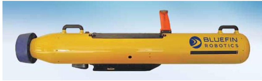
Figur 2.7: Bluefin-9 AUV [Vedlegg D].
