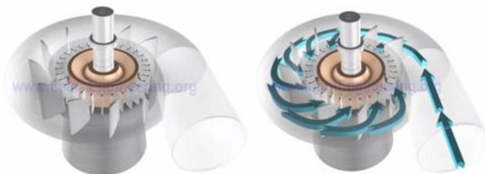
Figur 11 – plassering på faste og vribare ledeskovler [10]
