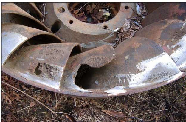
Figur 9 - Skade påført av kavitasjon [27]
