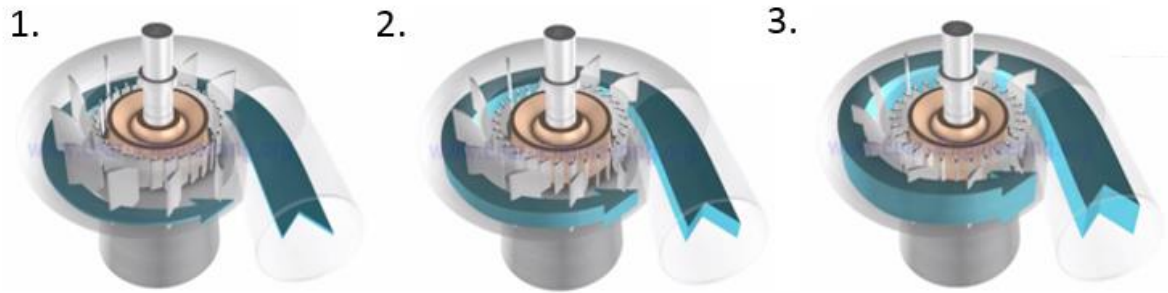
Figur 12 – ledeskovlene reguleres i forhold til vannet [10]
