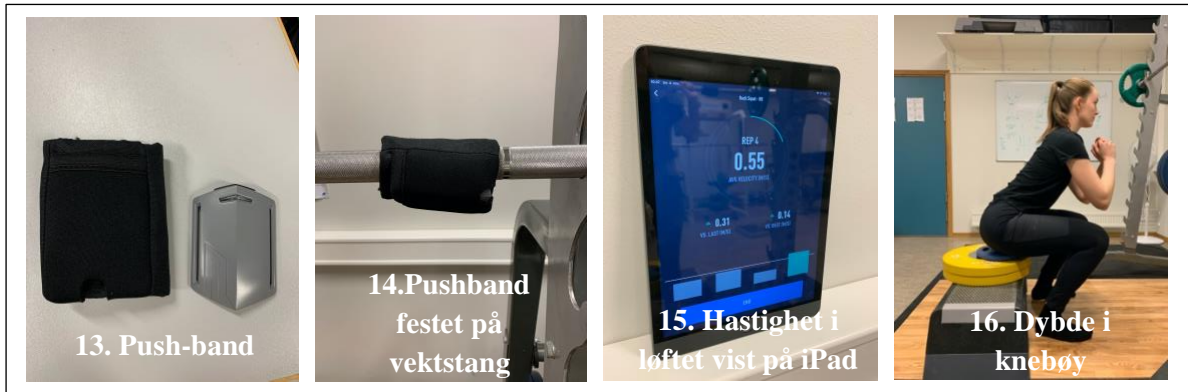
Figur 2: Bilde 13, 14 og 15 viser det digitale utstyret vi har brukt, bilde 16 viser standardisert dybde i knebøy.
