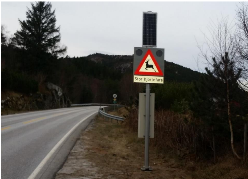
Figur 2. Utforming og oppsett av dei dynamiske hjortesilta. Solcella driv batteri i el-skap der ein m.a. også finn modem for kommunikasjon. Fareskiltet har to blinkande lys som slår seg på når det kjem melding om at terskelverdien for påkøyrslisiko er over ei viss grense. Her frå Brandsøy, RV5 rett før Florøy by. Foto. Magnus Frøyen.
