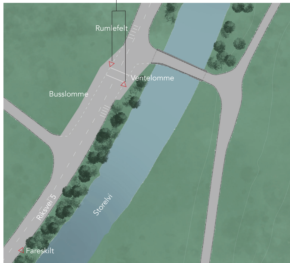
Figur 56: Illustrasjon av krysningsløsning ved Skeide og krysningsvarsel med utløserknapp og gult blink
