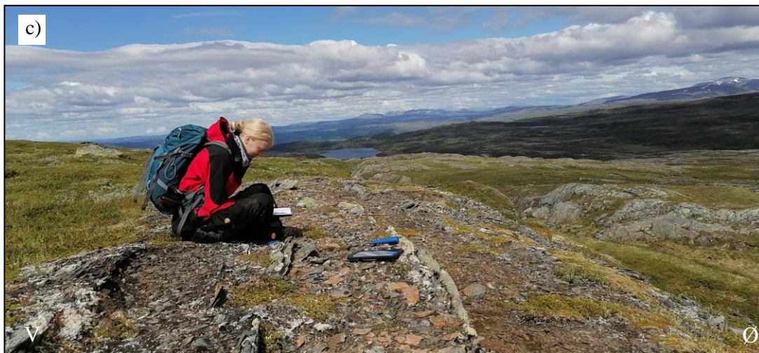
Figur 31. Foliationsmålinger. Storsirklene viser helningene og orienteringene til foliasjonen. a) Foliationsmålinger i Gulakomplekset. b) Foliationsmålinger i Fundsjøgruppen. c) Glimmerskifer i Gulakomplekset med en foliasjon som heller bratt mot vest.
