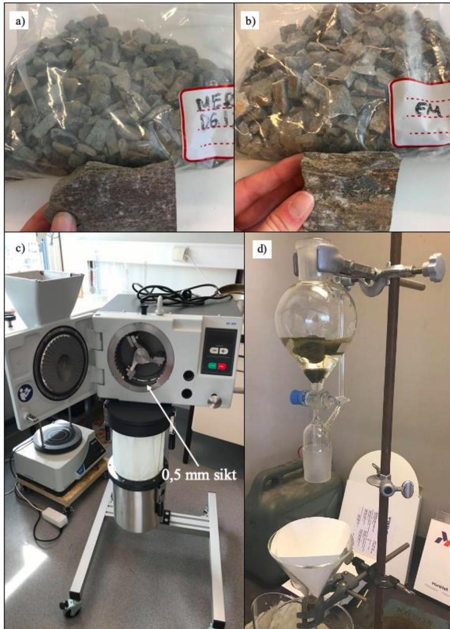
Figur 14. Separasjonsdelen av aldersdateringen som ble gjort ved Høgskulen på Vestlandet. a) Prøven fra Fundsjøgruppen (DG_12) som er metasediment. b) Prøven fra Gulakomplekset (EM_28) som er kvartsrik metasandstein. c) Møllen fra Retsch som ble brukt for å knuse bergartsprøvene. d) Separasjon av mineraler ved hjelp av LST tungvæske. De lettere mineralene vil flyte mens de tyngre vil synke.
