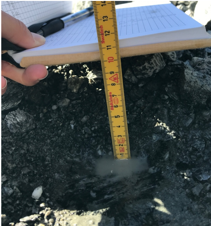
Figur 4: Tjukna på midtmorene 1 vart målt ved å grave hol ned til isoverflata. Tjukna vart målt med ein meterstokk.
