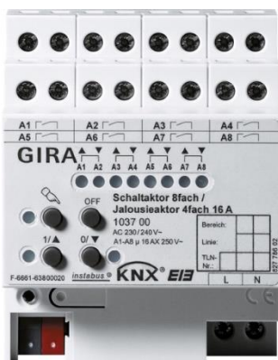
Figur 14 - KNX binærutgang/bryteaktuator med 8 utganger. Som vist har denne potensialfrie utganger. Spenningen på utgangen kan derfor velges, eksempelvis kan en her tilføre 24V dersom enheten skal styre 24V termoshuntventiler.
