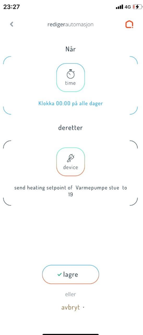
Figur 141 - Nattsenking av varmepumpe.
