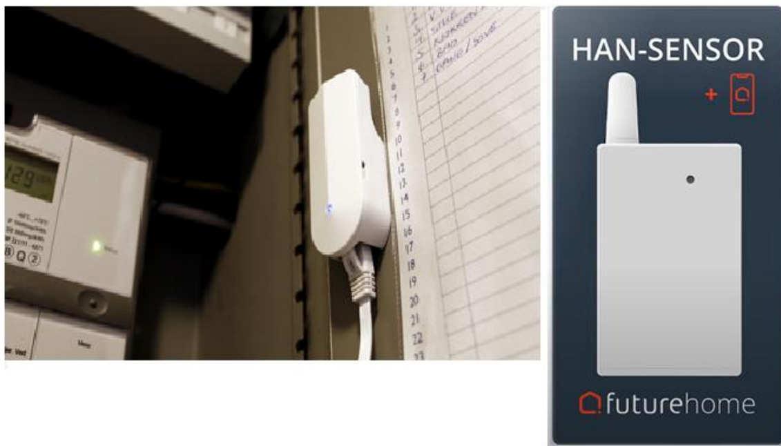
Figur 70 - Integrasjon av strømmåling via HAN-porten på AMS-målerne. Tibber Pulse til venstre.
