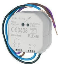
Figur 1 - Bryteaktuator i Eaton sitt xComfort-system; eksempel på trådløst pådragsorgan, populært kalt «pille».
