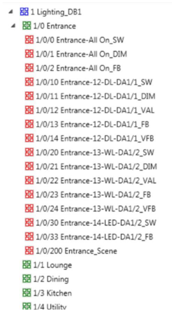
Figur 8 - Eksempel på gruppeadressering fra ETS hvor hvert rom har fått sin egen middle-gruppe.
