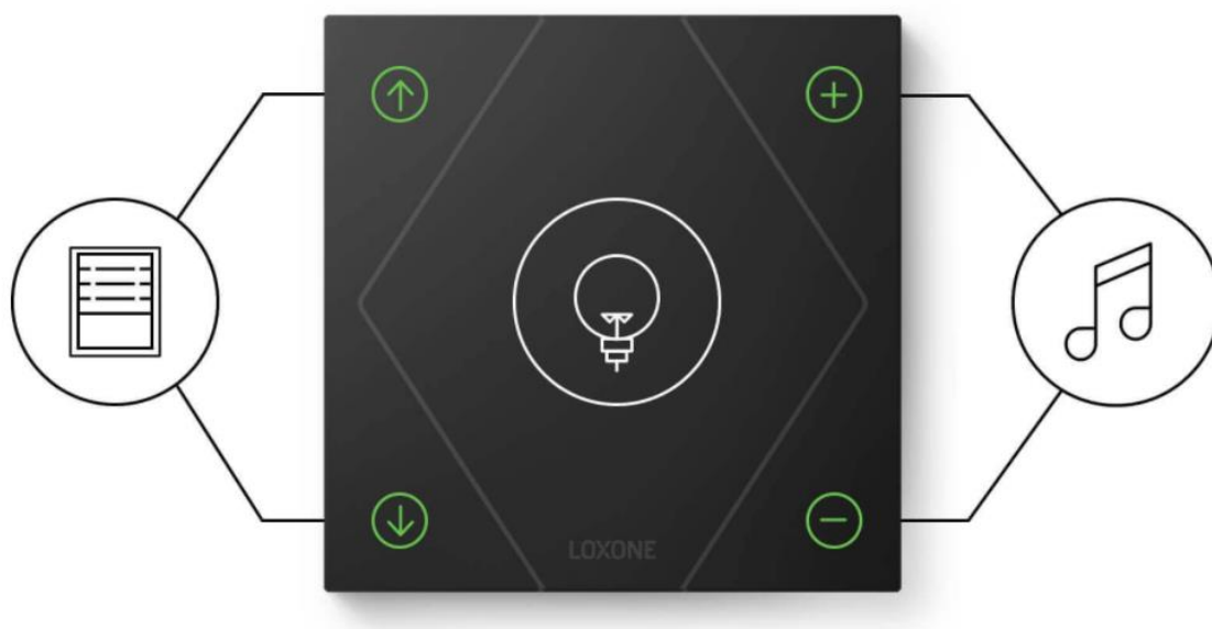
Figur 52 - Loxone bryter standard. Lyscener i midten, musikk-styring på høyre side, persienne-styring på venstre side. Dobbelklikk i midten skruer rommet av. Trippel-klikk i midten på soveromsbrytere etc. setter huset i nattmodus/bortemodus.
