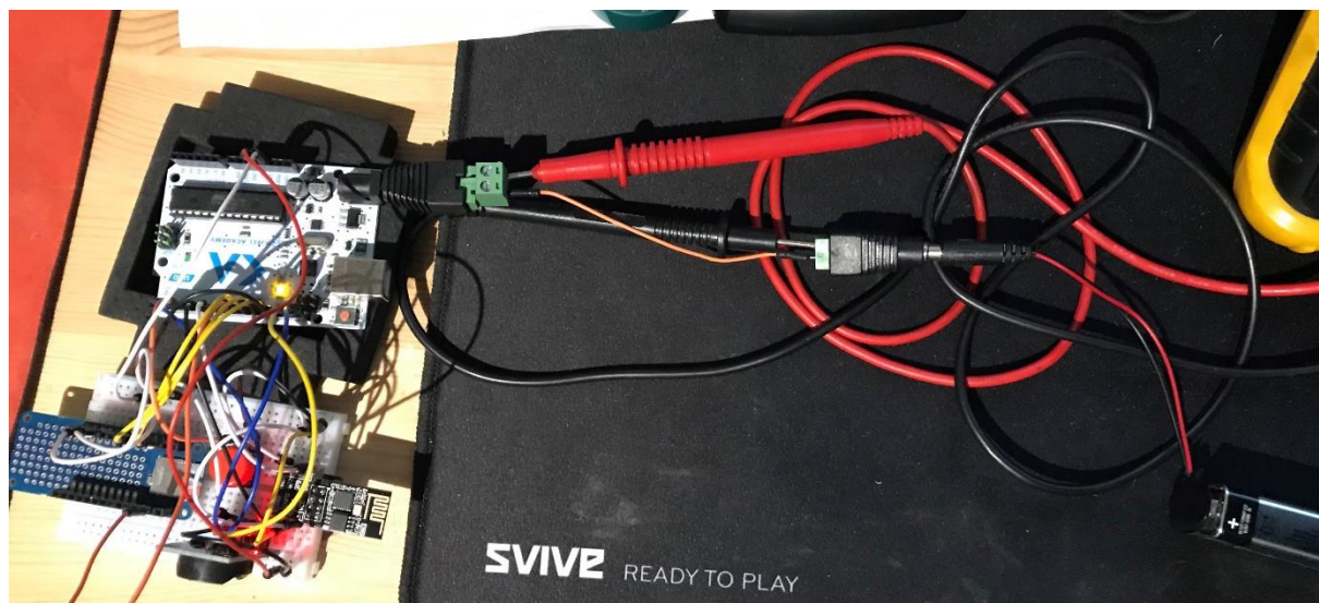
Figur 8: Bilde av testoppsett strømforbruk
