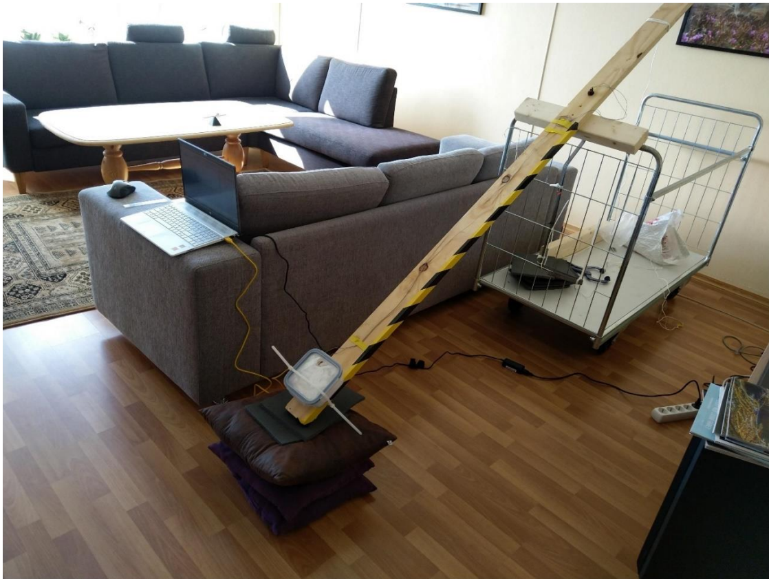
Figur 7: Praktisk implementasjon av fallrigg
