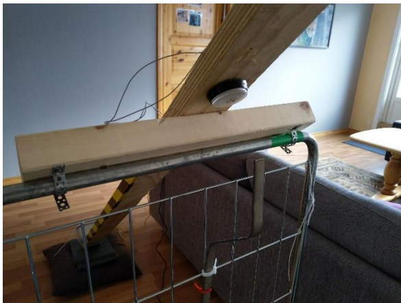
Figur 8: Knapp og stang for deteksjon av starten av eit fall
