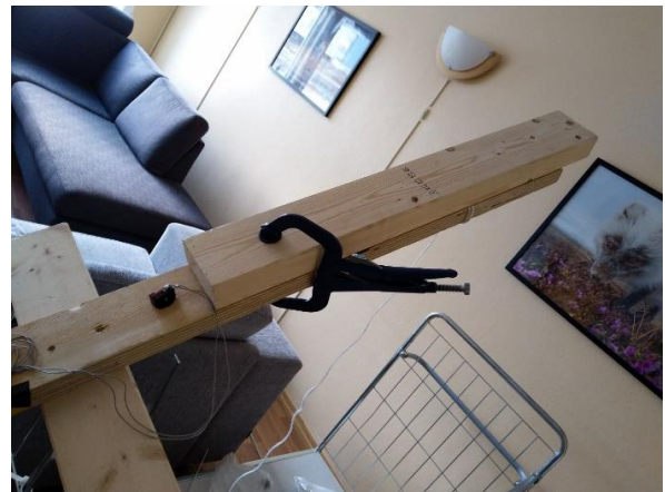
Figur 9: Justerbar motvekt lar ein teste fallsensoren med ulike akselerasjon under fallet
