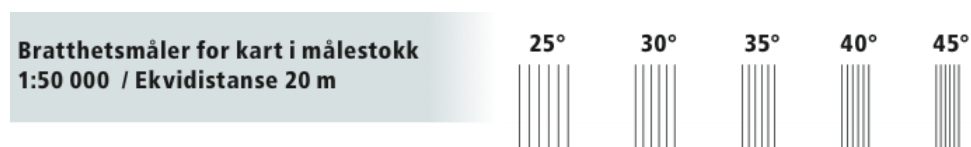
Fig 2.3: Bratthetsmåler for kart, hvor lengden mellom strekene indikerer brattheten (Skredkortet, 2013)
