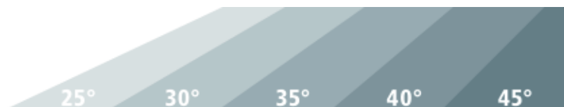
Fig 2.4: Bratthetsmåler for terreng, sammenlign terrenget med kortet (skredkortet 2013).
