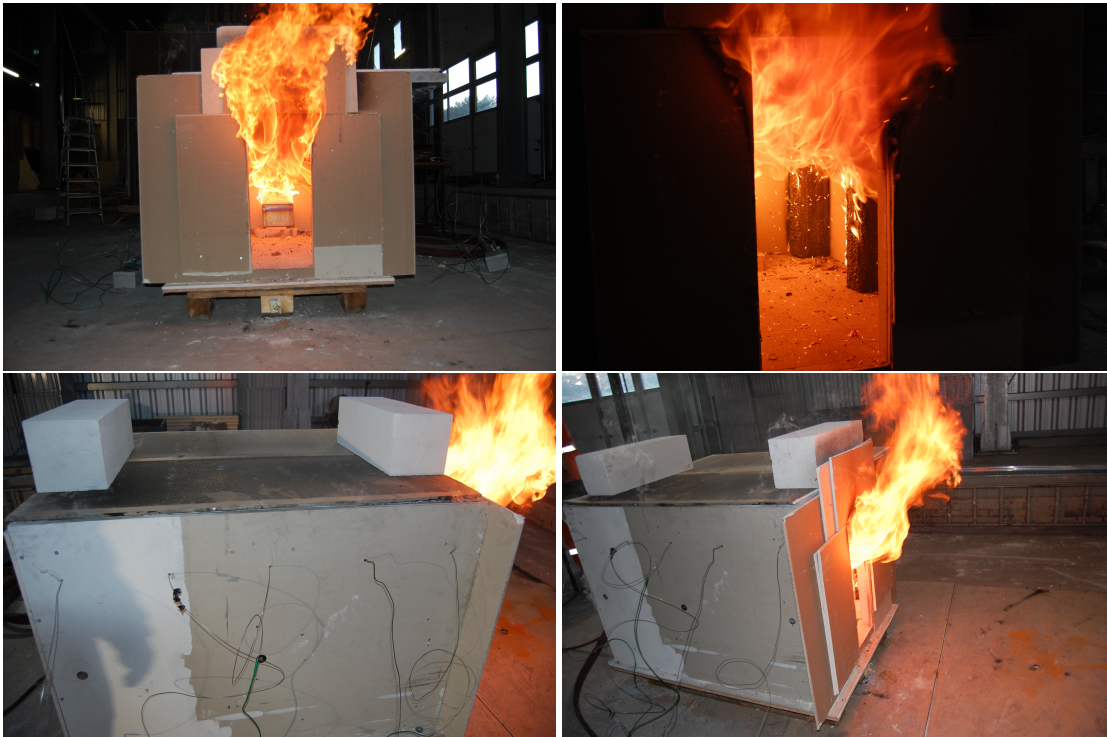
Figur 3.12: Bilder tatt under forsøkene, viser full overtenning av rommet
