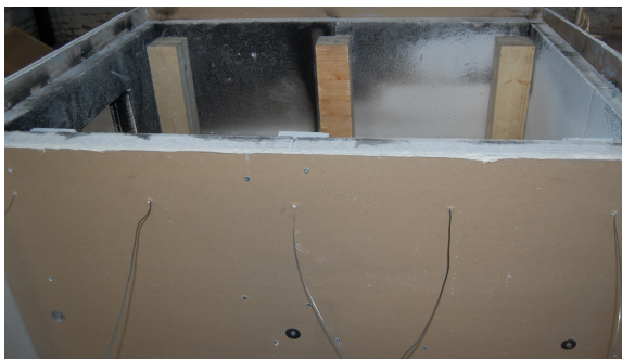
(a) Gjennomføring av termoelementer og skruefest til teststykker. Viser gjennomføring/feste fra utsiden.
