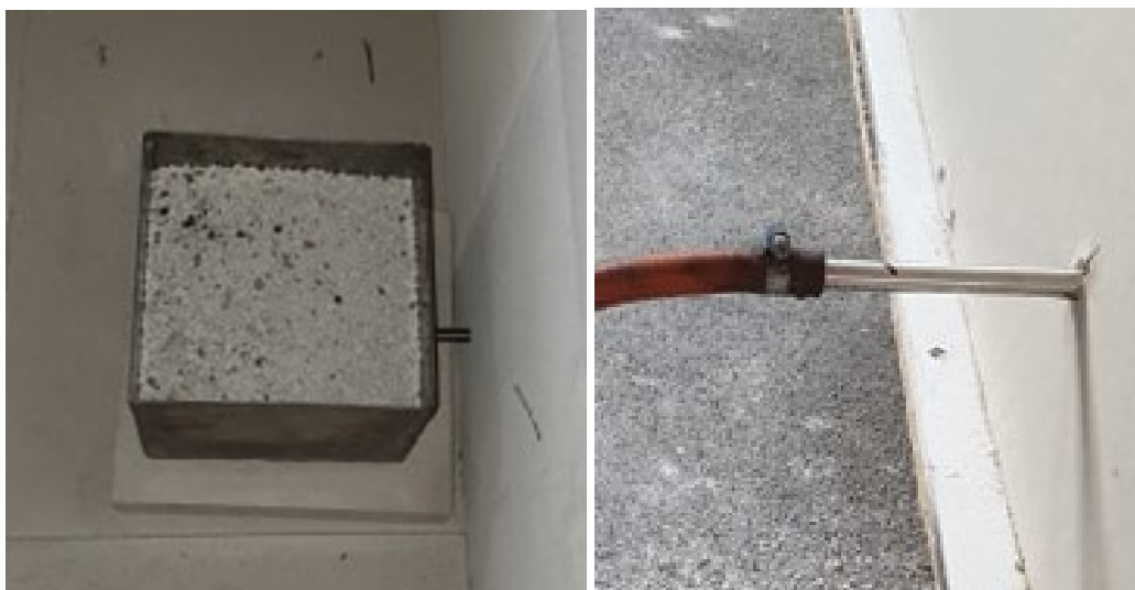
Figur 3.4: Bilde av Gasbrenner og oppkobling av slange for gasstilførsel til brenner
