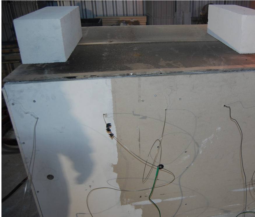
Figur 3.11: Brannrom med tak og ekstra vekt på taket
