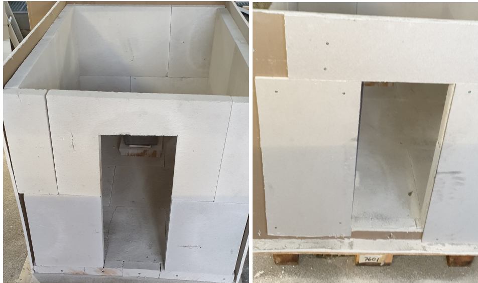
Figur 3.5: Bilde av frontvegg med og uten gipsplater
