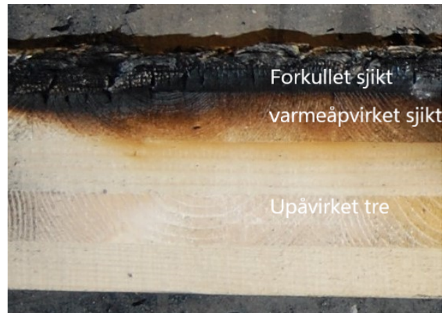
Figur 2.6: Bilde som viser forkullet lag, varmpåvirket lag og upåvirket lag i et av teststykkene. (bilde er tatt av forfatteren selv)
