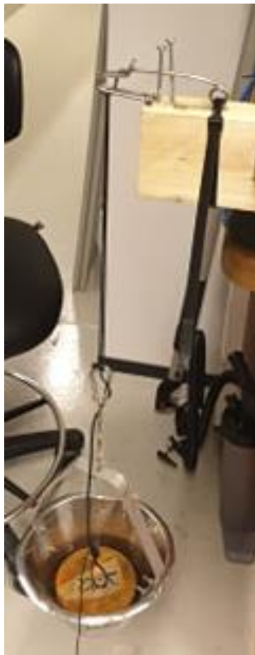
Figur 4-9: Test av klypekrokens holdeevne.
