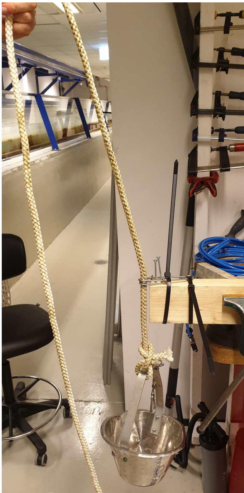
Figur 4-12: Friksjonstest av originalklipsen med 13mm nylontau.
