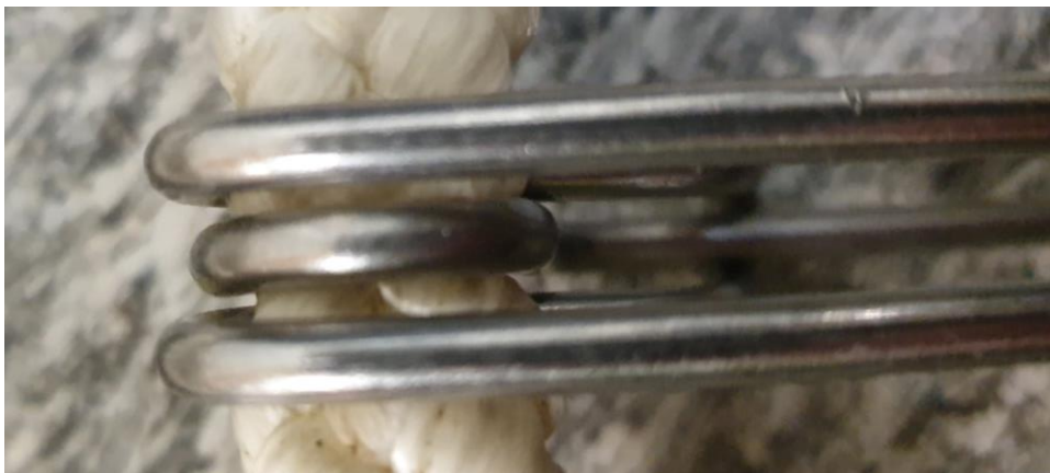
Figur 4-17: Originalklipsens press på 13 mm nylontau sett ovenfra.
