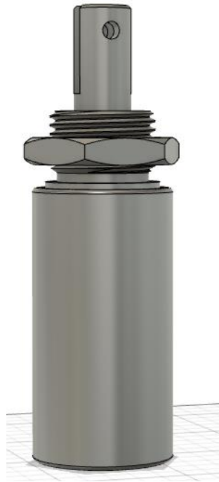
Figur 4-14: Solenoid som drar til seg jernelementet inn i kroppen.
