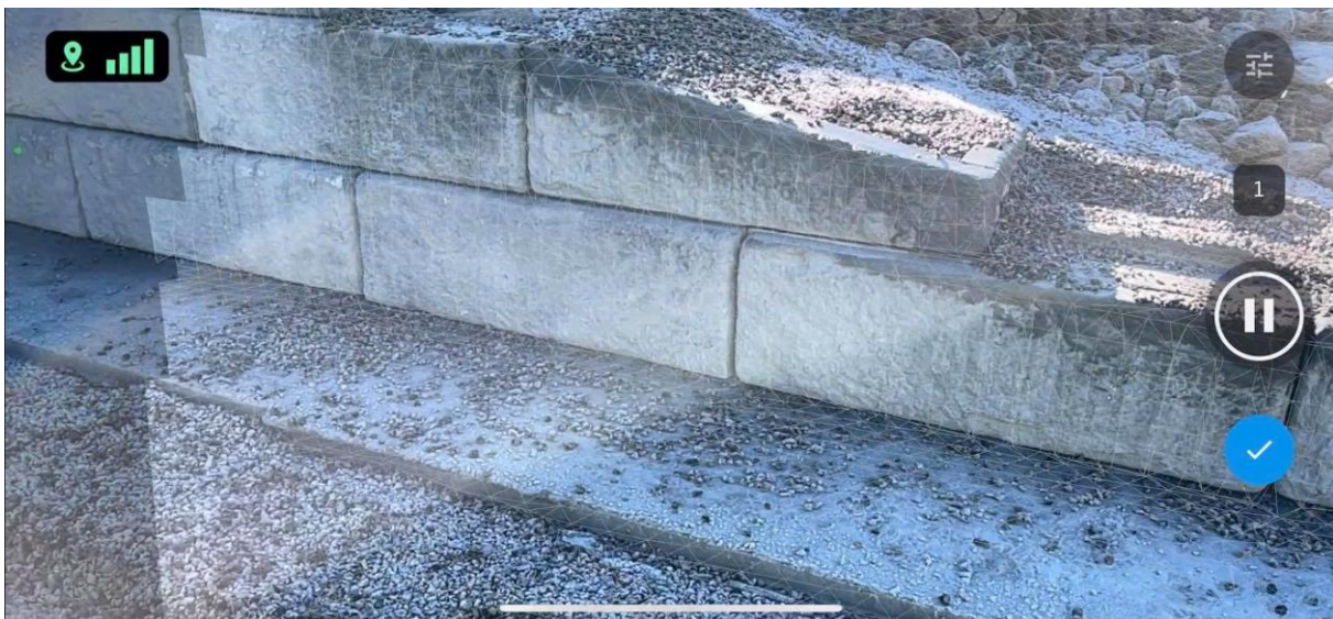
Figur 19: Skjerm bilde fra iphone som ble tatt under datafangst. Bildet viser hvordan et slags triangelnett som viser hvor skanneren har samlet inn data.
