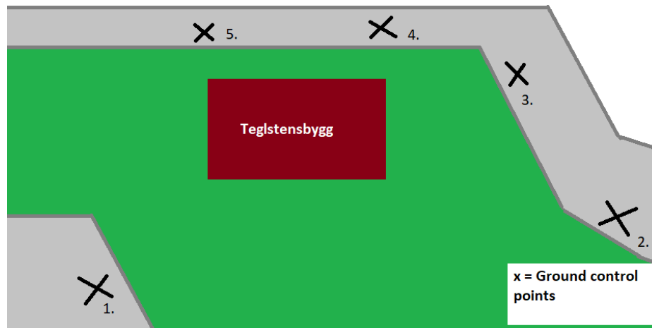
Figur 22: Illustrasjon som viser hvordan spredningen av GSP rundt objektet.
