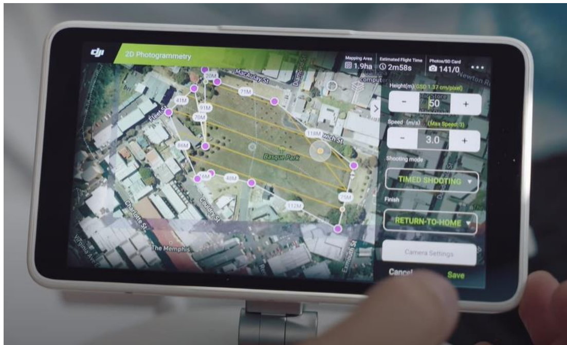
Figur 29: Illustrasjon av kartlegging av flyveplanen på kontrolleren til dronen (Ferntech, 2019).
