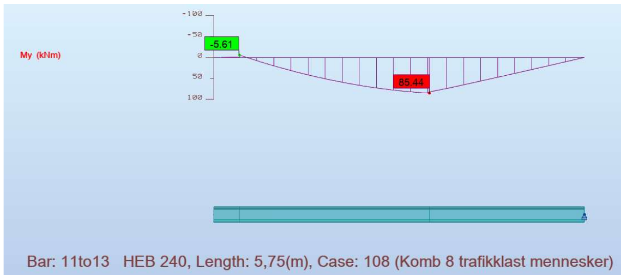
Figur 20: Utklipp fra Robot med momentdiagram for den mest påkjente bjelken.
