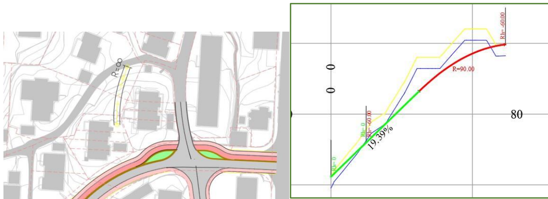
Figur 40: Alternativ kjørevei til eiendommen via Nordahl Rolfsens vei med tilhørende lengdeprofil
