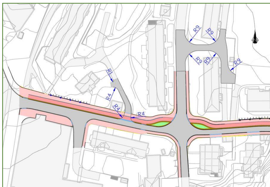
Figur 27: Radiuser avkjørsler vestre del
