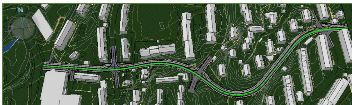
Figur 30: Utklipp fra Novapoint, stoppsiktanalyse primærvei
