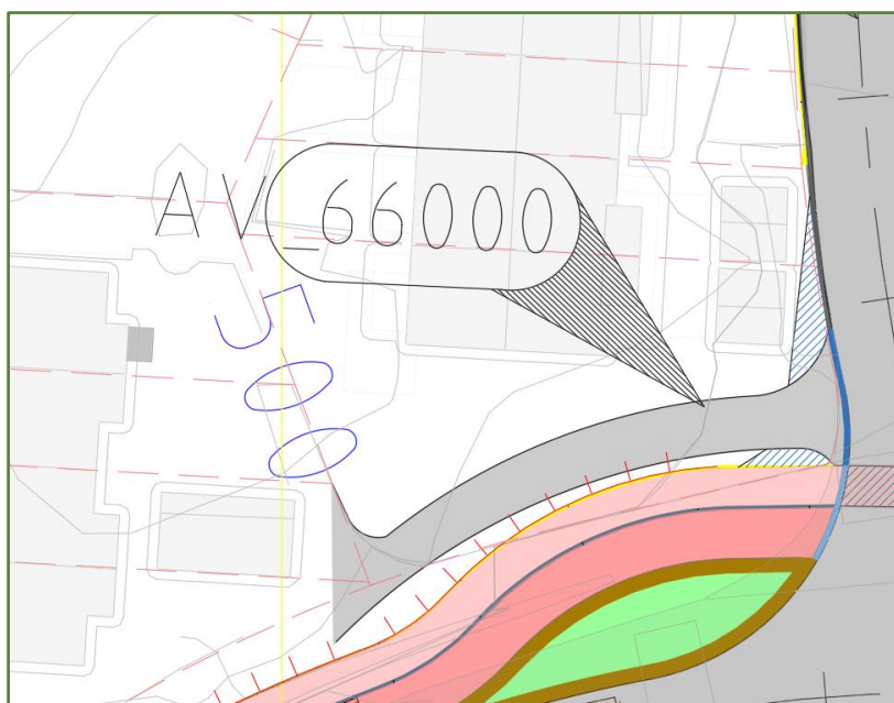
FIGUR 52: PROSJEKERT AVKJØRSEL 66000, UTKLIPP FRA C-TEGNING
