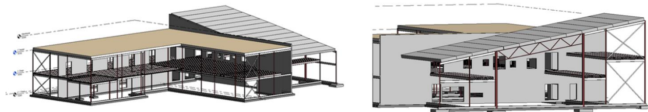
Figur 28 - Bæresystem modellert i Revit.
