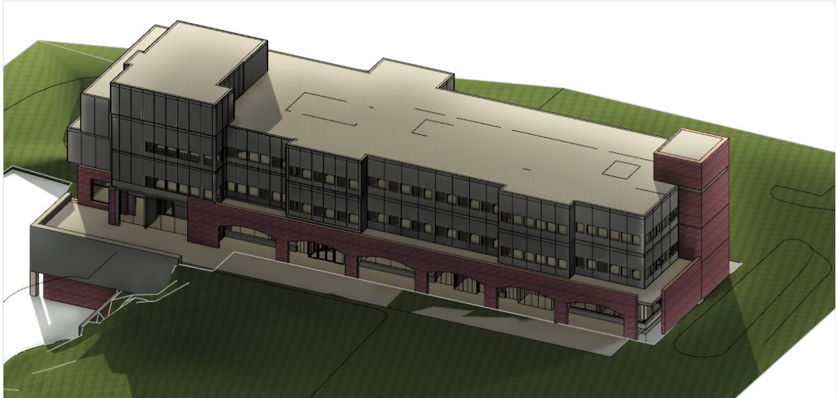
Figur 30 BIM-modell Kokstadflaten 4 LOD 200
