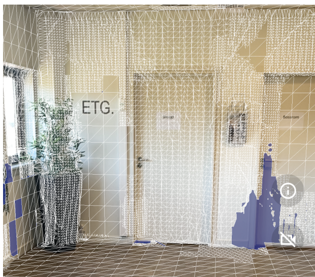
Figur 27: Skannespross ved bruk av Polycam App
