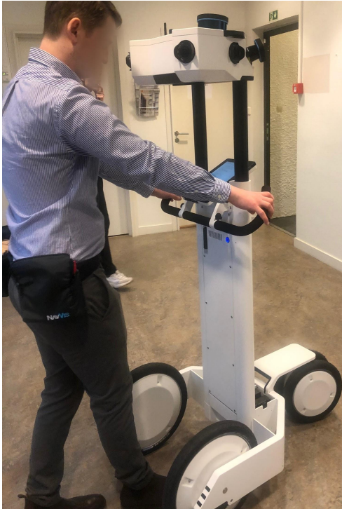
Figur 10 NavVis M6 skanner [94].
