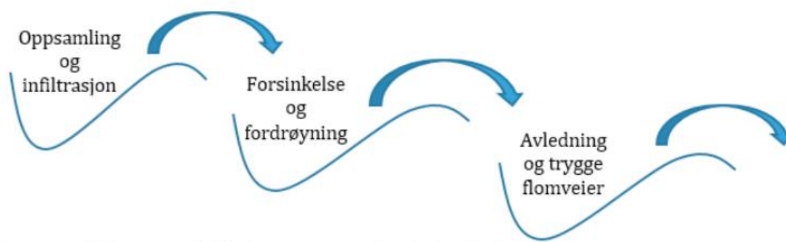
Figur 3 Tredleddsstrategien for handtering av overvatn (Røysted, U.E. 2016)
