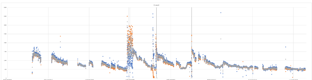
Figur 12 Eksempel på graf av U-verdier fra H1. Denne veksleren bruker kun ferskvann hele året.
