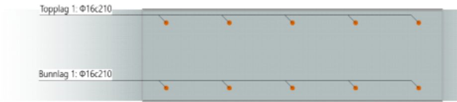
Figur 56: Armering for vegg mot fjellside
