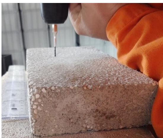
Figur 14 Småskalaforsøk 1 - Boring i polybetongen
