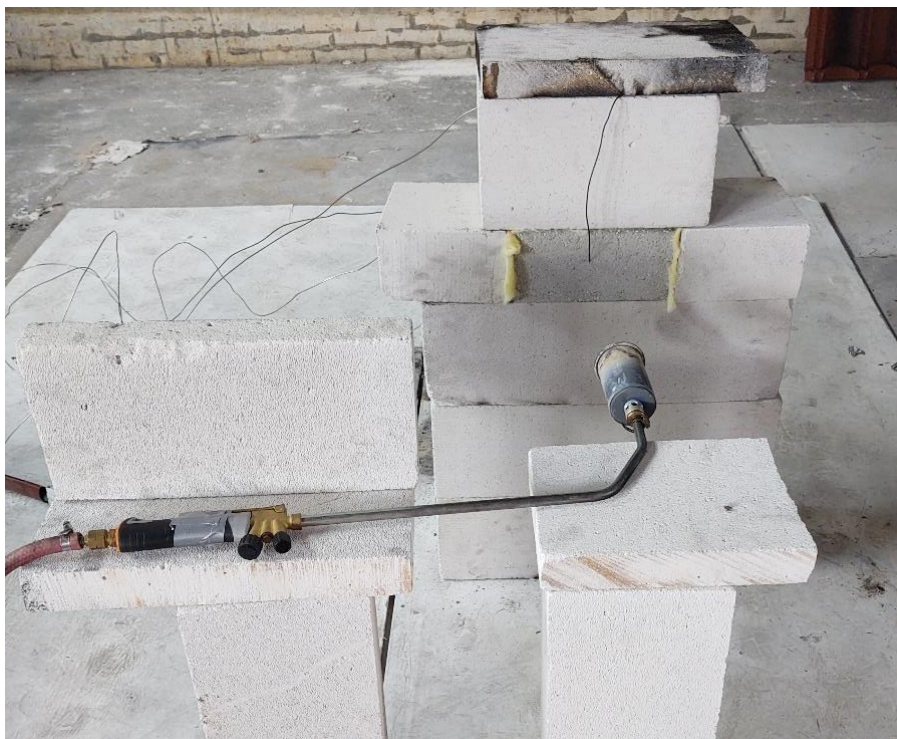
Figur 13 Småskalaforsøk - Gassbrenner og termoelement varm side
