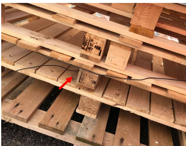
Figur 6 Fullskalaforsøk - Termoelement plassert i venstre stabel (kanal 19)
