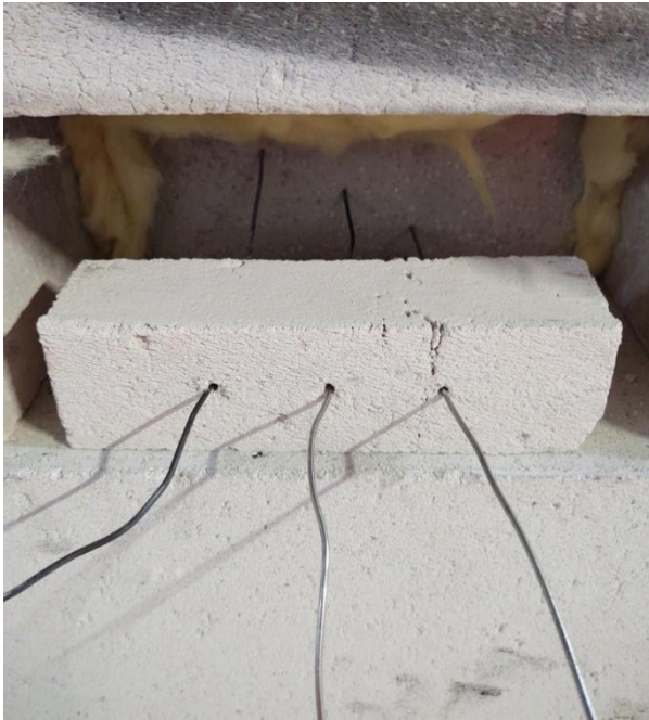
Figur 16 Småskalaforøk 2 - Termoelement kald side
