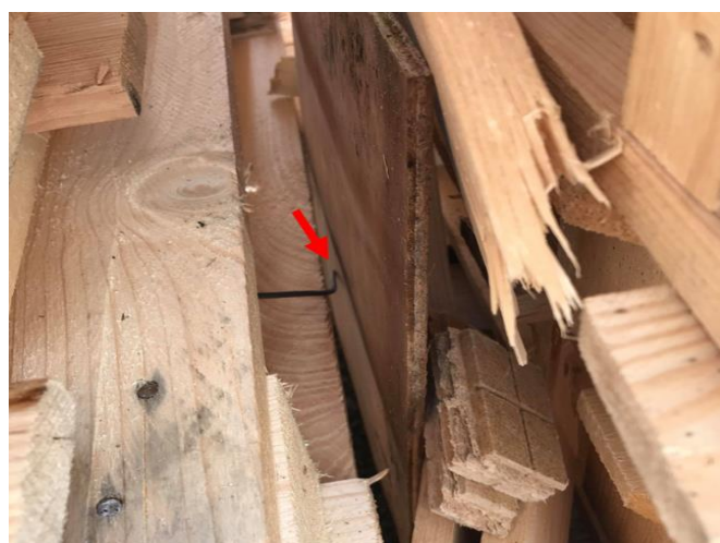
Figur 7 Fullskalaforsøk - Termoelement plassert mellom stablene (kanal 20)
