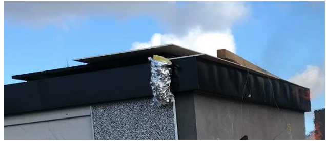
Figur 8 Fullskalaforsøk - Skjerming av solcellepanel og utvendige ledninger
