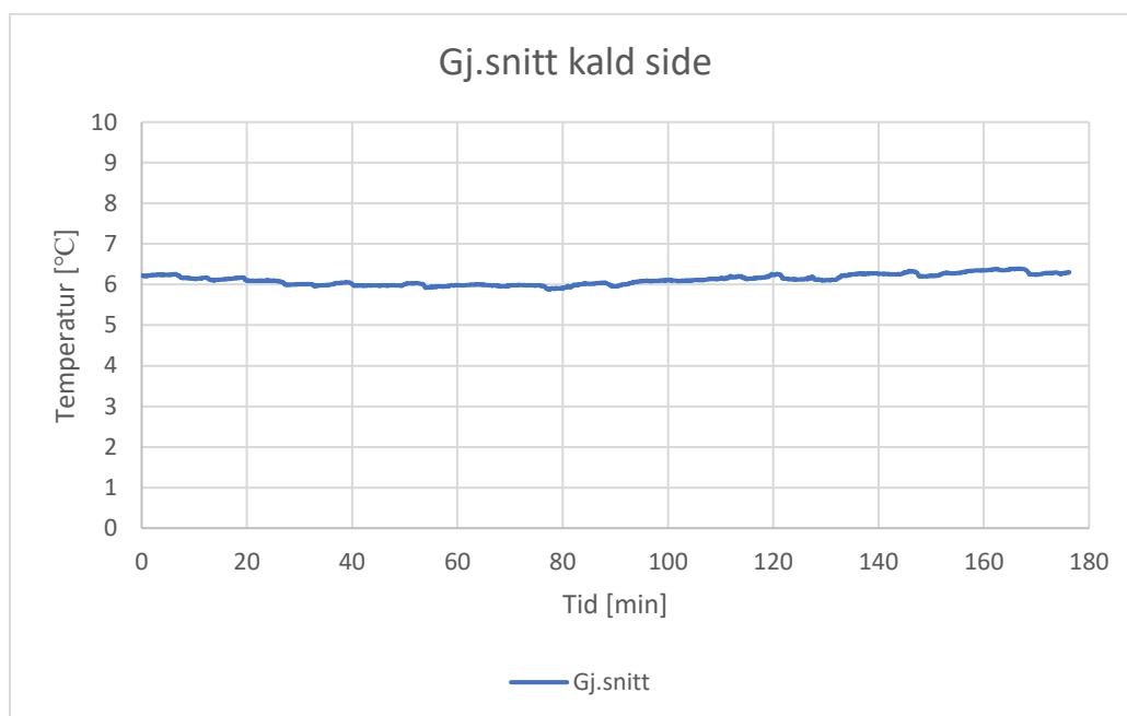
Figur 24 Fullskalaforsøk - Gjennomsnittstemperaturmålinger inne (Kald side)
