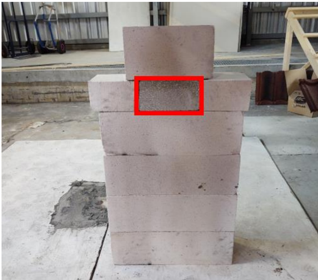
Figur 12 Småskalaforsøk – Rigg (Rød markering viser plassering av prøvestykket)
