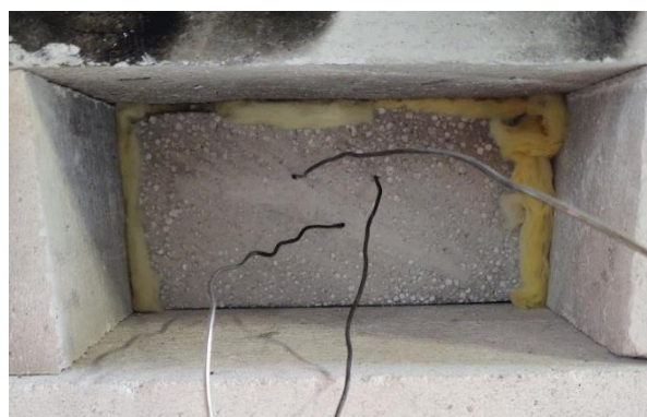
Figur 15 Småskalaforsøk 1 - Termoelementer kald side
