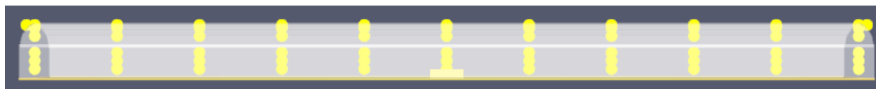
Figur 27 - Plassering av målepunkter for temperatur og hastighet i tunnel med lengde 100 m
