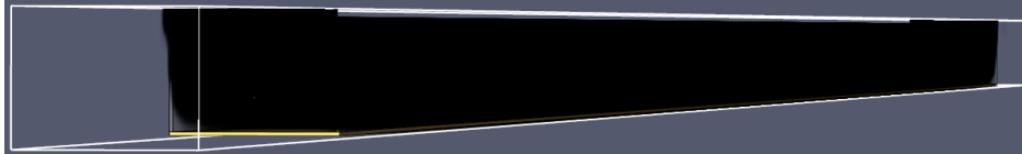
Figur 55 - Røykstrømning etter 20 minutter ved lastebilbrann
