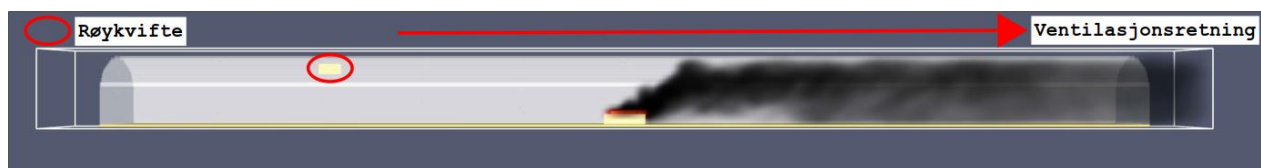
Figur 15 - Brann/røykvifte i tunnel, modellert i Pyrosim
