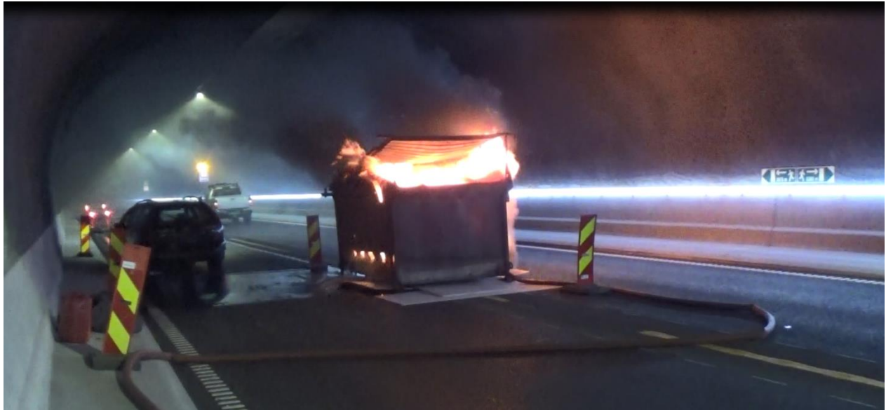
Figur 66 - Bildeutsnitt fra video av brannforløpet, 20 minutter etter påsatt brann.
