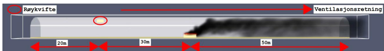
Figur 16 - Plassering av brannvifte i 100 m tunnel
