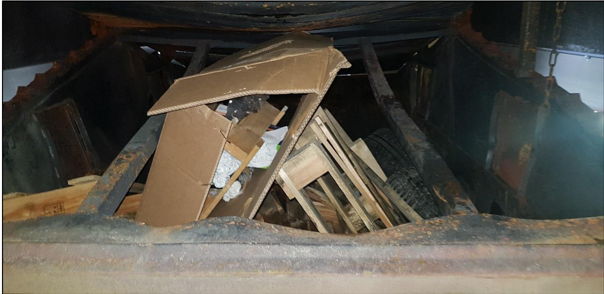
Figur 33 - Branninnholdet for brannøvelsen i Mælefjelltunnelen
