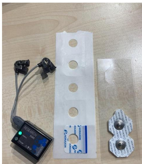
Figur 4. Viser utstyr som ble brukt direkte på testpersonen. Fra venstre: Research DTS sensor, dobbeltsidig teip til sensor og Noraxon dual electrode.
