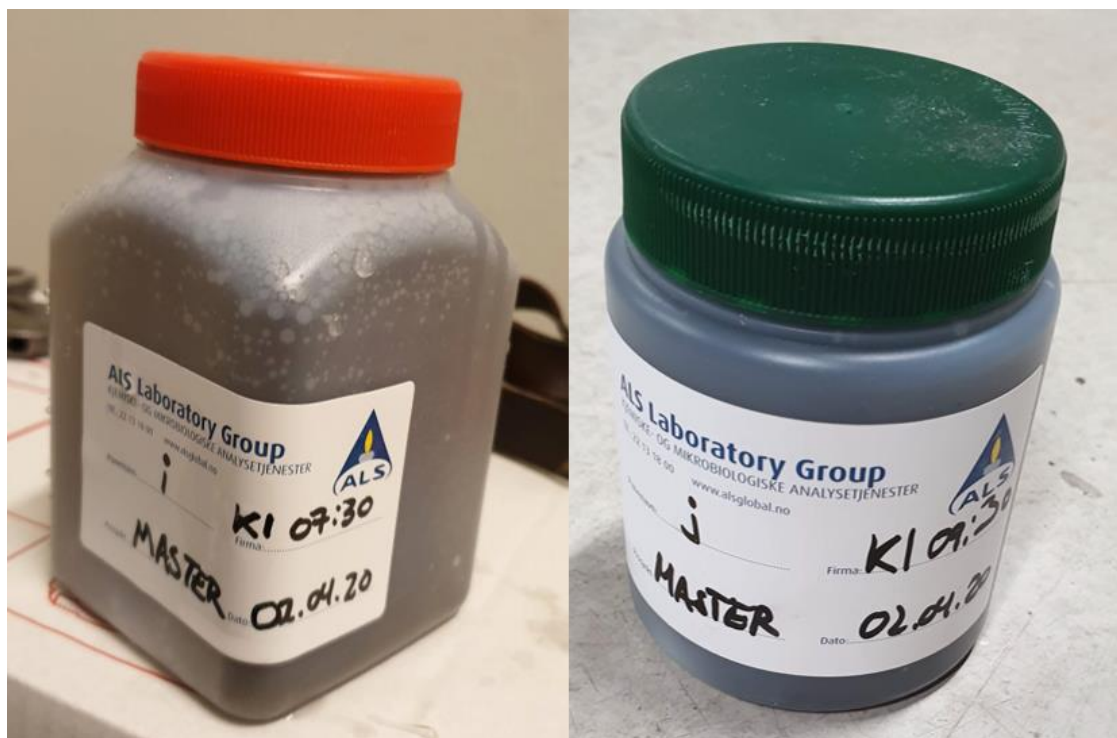
Figur 20 - Eksempler fra vannprøvetaking med tydelig fargeforandring
