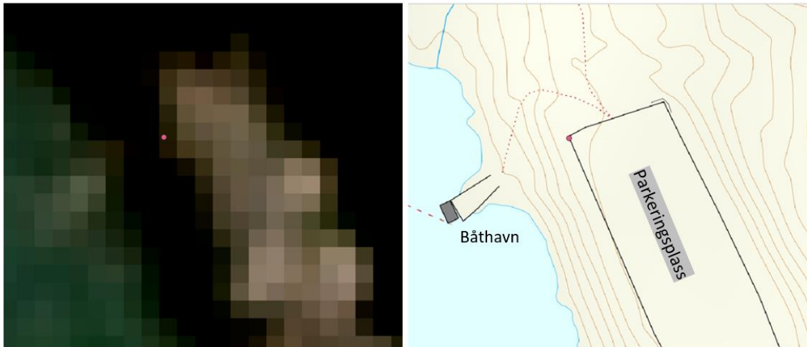
Figur 17 Referansepunktet ved hjørnet av parkeringsplassen (rosa punkt). Bilde til venstre (Image courtesy of Planet Labs Inc., 2019) er lastet ned fra planet, og er tatt 26.07.2019. Bilde til høyre er et utklipp fra topografisk norgeskart med samme utsnitt. Referansepunktet ble målt ved asfaltkanten av parkeringsplassen. Utenfor asfaltkanten ligger det grus, og denne er ikke mulig å skille fra asfalten på satellittbildet.
