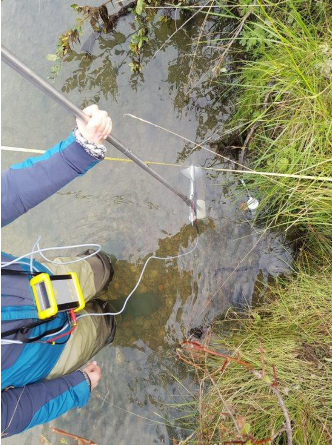
Figur 7 - Bildet viser OTT C31 Universal Current Meter under vann, og OTT Z400 Signal Counter Set henger rundt nakken til operatøren. Bildet er tatt 07.09.19.
