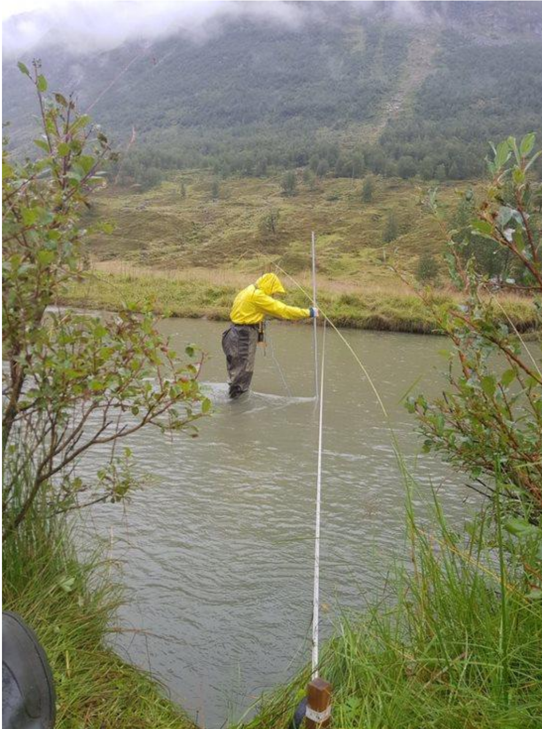
Figur 9 - Vannhastighetsmålinger blir utført. Operatøren holder god avstand til flügelen. Bildet er tatt 22.08.19.
