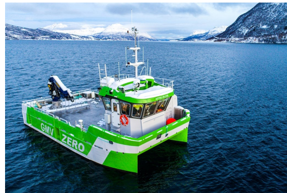
Figur 5 – «GMV Zero», helelektrisk røkterbåt med katamaran skrog
