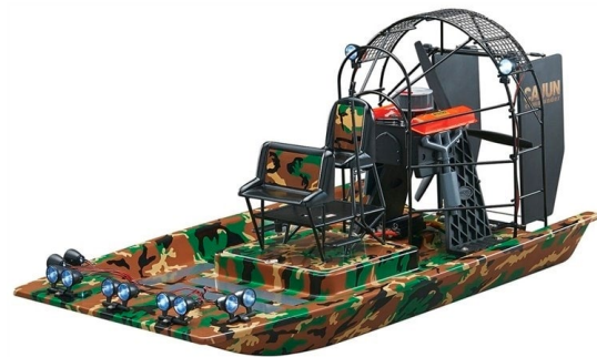
Figur 9 – Sumpbåt som blir drevet fremover ved hjelp av en stor vifte [10]
