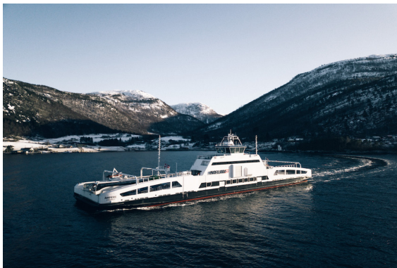
Figur 4 – «MF Ampere», helelektrisk ferje med katamaran skrog
