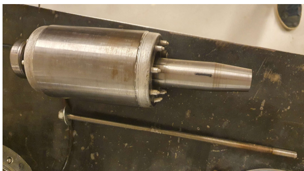
Figur 30: Generator og festebolt
