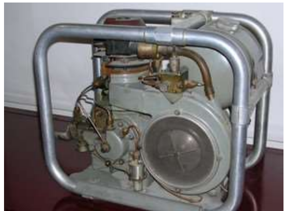
Figur 2: Philips' Stirlingmotor fra 1952
