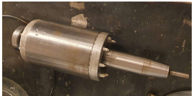
Figur 29: Generator med festebolt på plass
