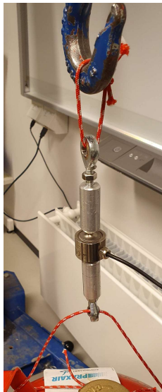
Figur 42: Oppheng vektcelle og propan
