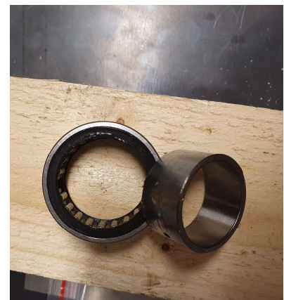
Figur 44: Rullelagrene som brukes i motoren, med den indre ringen på siden
