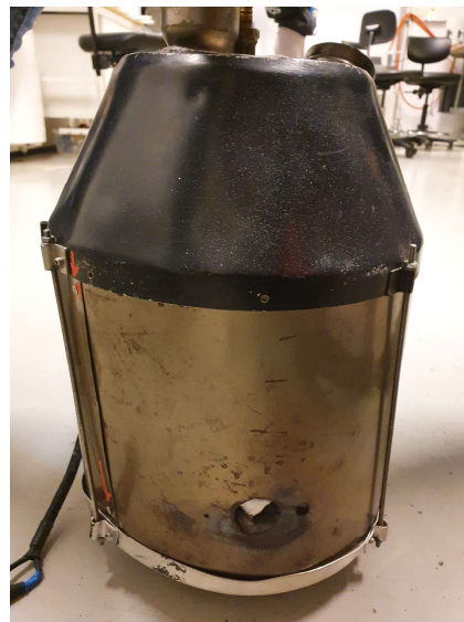
Figur 10: Brennkammer, hull for tenning av propan nede på kammeret
