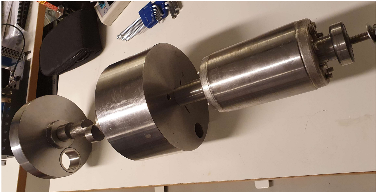
Figur 31: Sammensetning veivaksel med motvekt og generator
