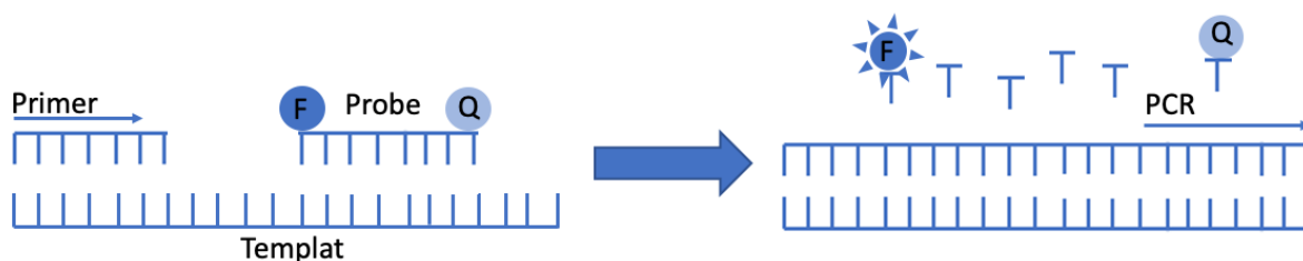
FIGUR 9: FREMSTILLING AV HVORDAN EN FLUOROFOR FUNGERER. «F» REPRESENTERER FLUOROFOREN ELLER REPORTEREN, MENS Q REPRESENTERER QUENCHEREN. PROBEN BINDER SEG MELLOM PRIMERNE. NÅR DNA-POLYMERASEN PASSERER PROBEN, SPLITTES DEN TIL ENKLE NUKLEOTIDER. DA SKILLES REPORTEREN OG QUENCHEREN FRA HVERANDRE, QUENCHEREN KAN IKKE LENGER FANGE OPP LYSENERGIEN FRA REPORTEREN, OG DET FRIGJØRES DERMED ET SIGNAL SOM KAN DETEKTERES VED BESTEMTE BØLGELENGDER.
