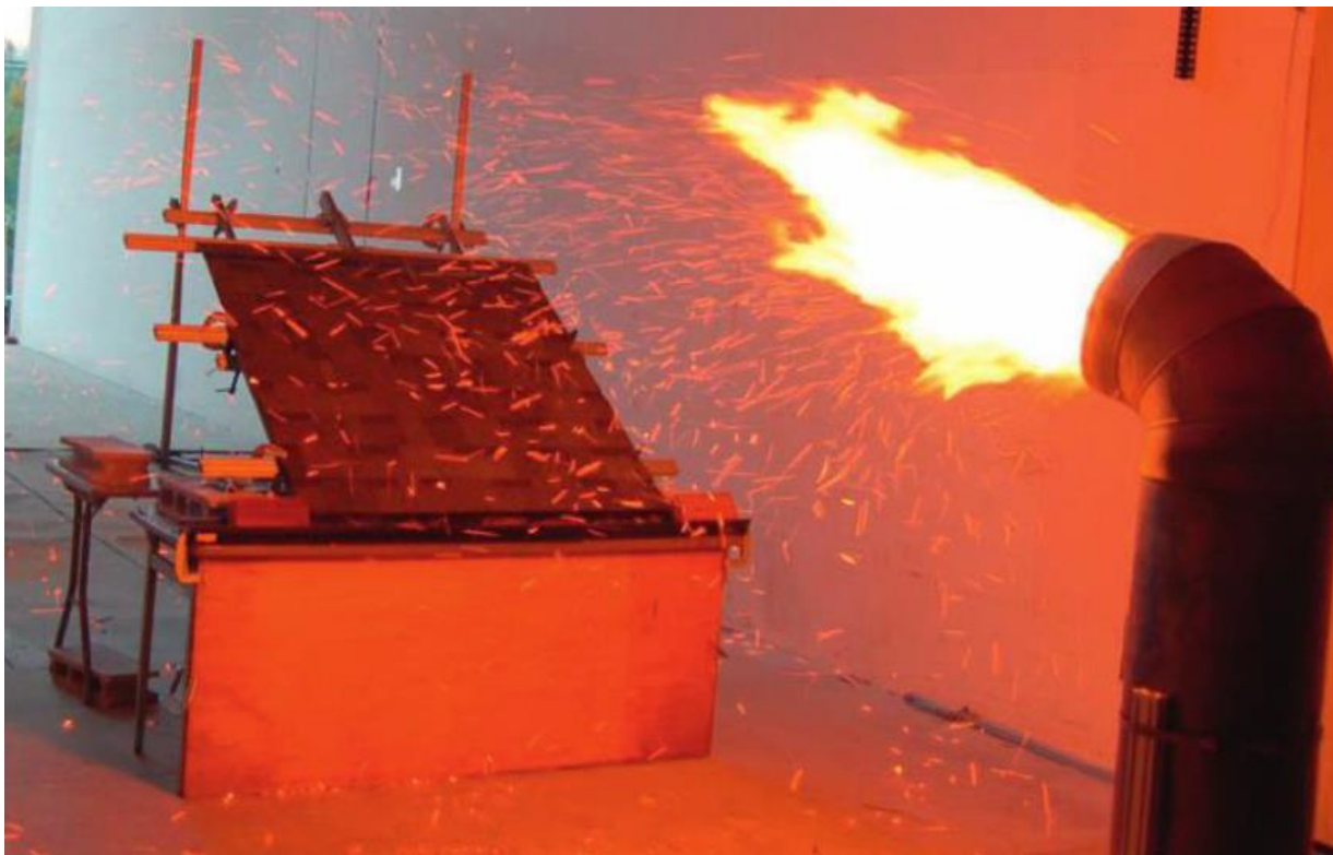
Figur 14: Bildet er tatt under testing av takteking av asfaltshingel.
