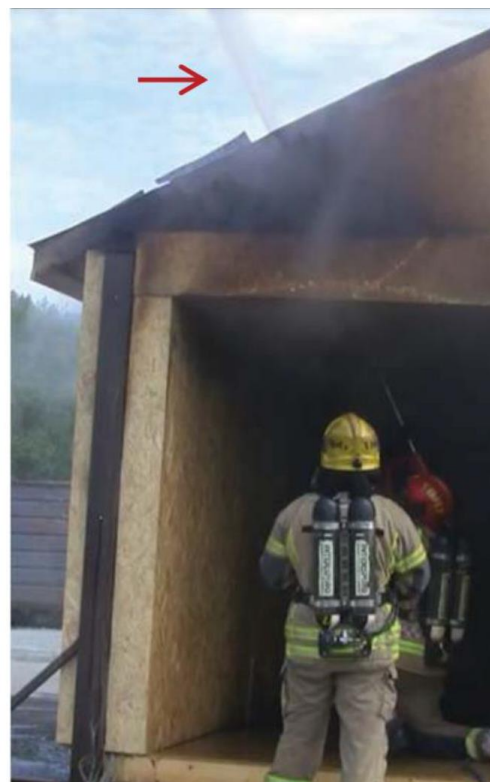
Figur 51: Slokking fra korridor og opp i loftet. Strålen har vært for lenge på samme punkt og skjært seg gjennom tre OSB-plater. Mesteparten av vannet forsvinner ut i lufta [63].
