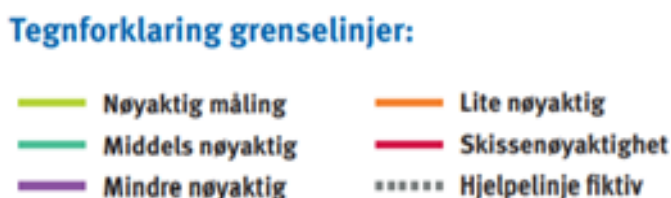
Figur 2: Illustrerer fargekode for grenser i matrikkelen. De forskjellige fargene angir nøyaktigheten grensene er registrert med. Hentet fra Statens Kartverk.
