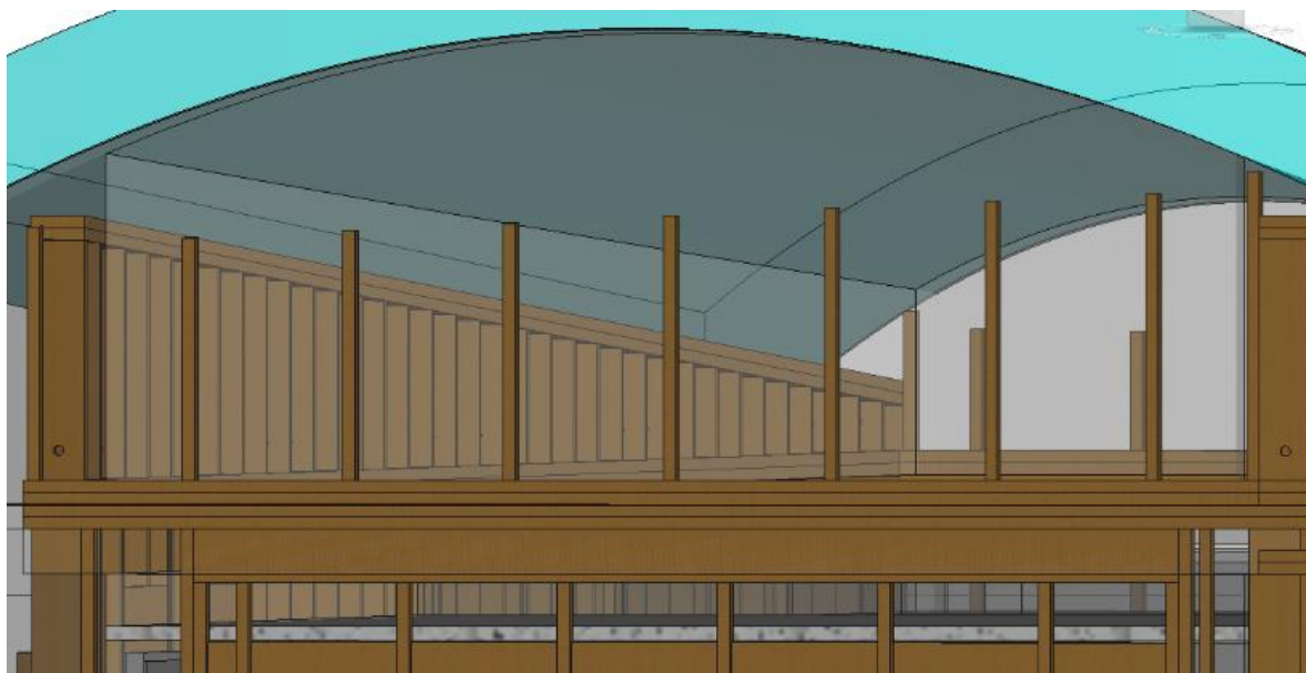
Figur 18 Stenderverk stopper før tak
