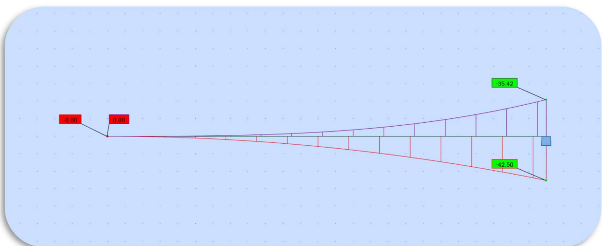
Figur 25: Moment- og skjærkraftdiagram til øvre utkrager (Coratti/Tesdal, Robot 2020)
