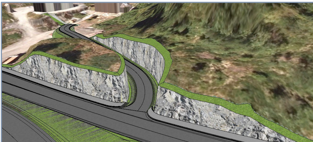
Figur 46: Avkjørsel 64000, skjermdump fra Novapoint.
