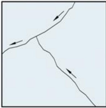
Figur 2.5: Bruddmønster etter bøyings- eller vridningspåkjenning [6]
