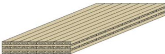
Figur 3.1 Krysslagte massivtreelementer (hentet fra Treteknisk.no)
