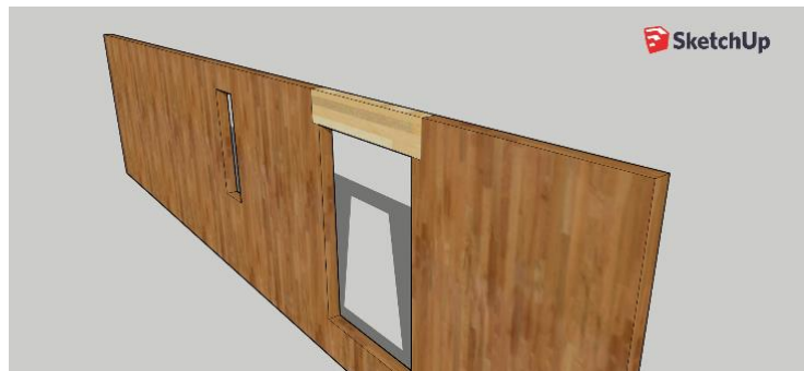
Figur 40: Illustrasjon av limtrebjelke over dimensjonerende utsparing
