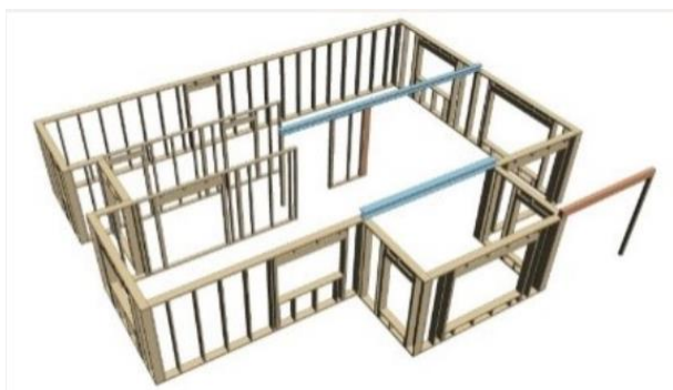
Figur 6: Oversikt over byggemetoden Precut-system. Hentet fra TreFokus.
