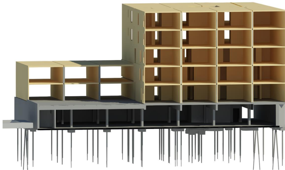
Figur 51: Et snitt som viser oversikten av bæresystemet i massivtre.
