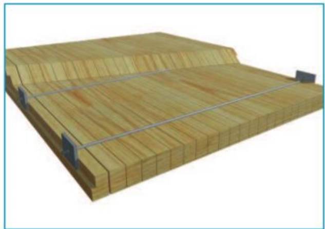
Figur 7: Tverrspent brodekke. Hentet fra Treteknisk.
