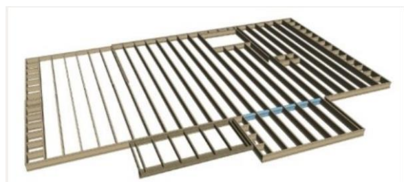
Figur 6: Oversikt over byggemetoden Precut-system. Hentet fra TreFokus.
