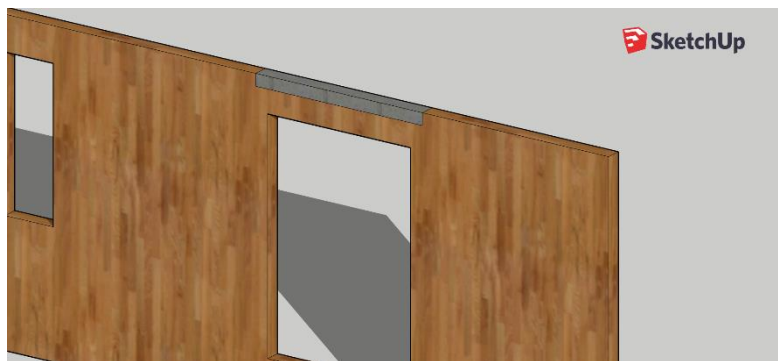
Figur 42: Illustrasjon av innfrest kanalprofil på 1.4 meter over utsparing
