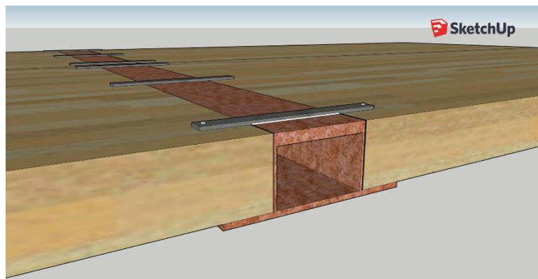
Figur 43: En oversikt av hatteprofilet med torsjonslåser.
