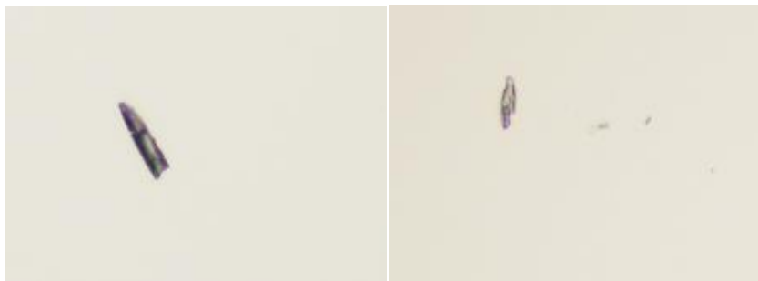
Figur 31: Mikroskopbilder av 0.0100 wt % av CCM i MDEA (venstre), og 0.0300 wt % av CCM i MDEA (høyre).
