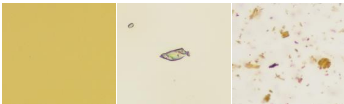
Figur 32: Mikroskopbilder av 0.1000 wt % av CCM i [Bmim]FeCl 4 (venstre), 0.1000 wt % av CCM + 0.85 % av vann i [Bmim]FeCl 4 (midten), og 0.1000 wt % av CCM + 95 % av vann i [Bmim]FeCl 4 (høyre).
